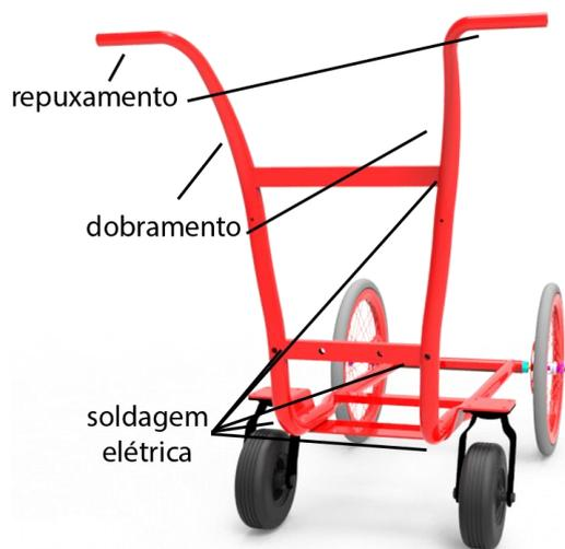
Figura 128: Indicação de algumas etapas para fabricar o chassi.
