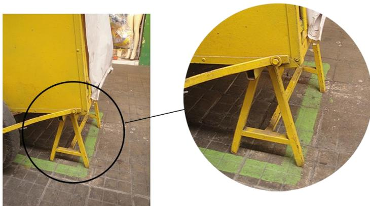
Figura 27: Detalhe de um cavalete para travamento do veículo.
