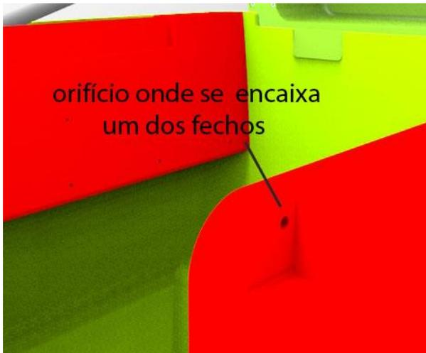
Figura 134: Local de encaixe da fechadura central no suporte do guarda sol.
