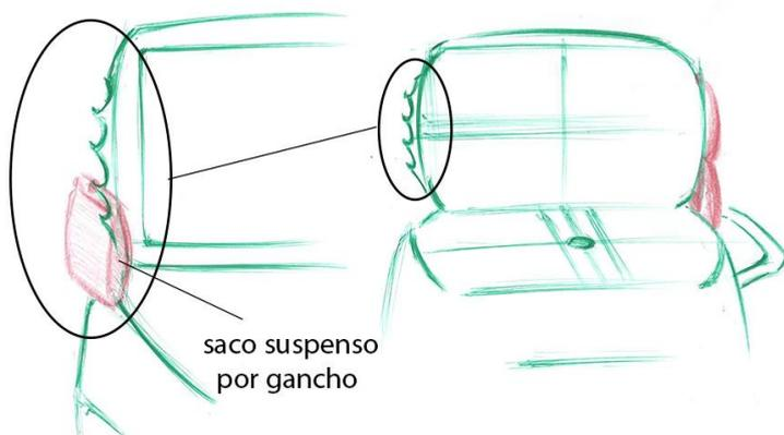
Figura 93: Sistema de suspensão de sacos por ganchos.
