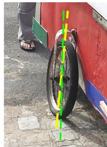
Figura 16: Detalhe da roda empenada; em verde, o eixo vertical, em amarelo, o eixo da roda alterado.
