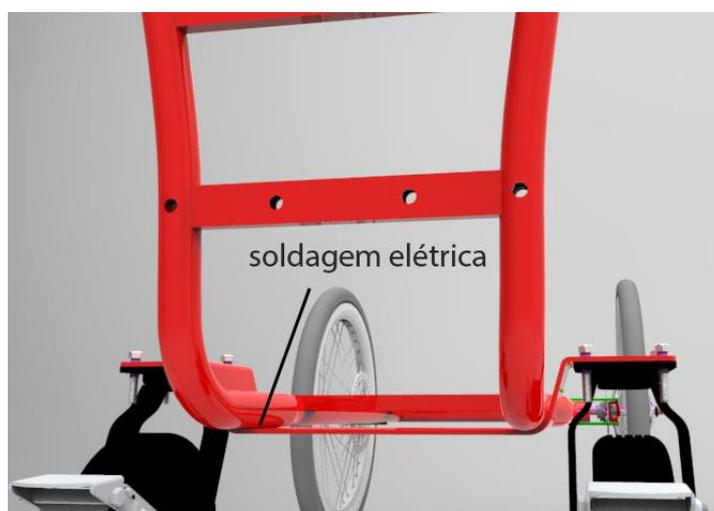
Figura 97: Indicação da chapa na qual se fixam os rodízios.
