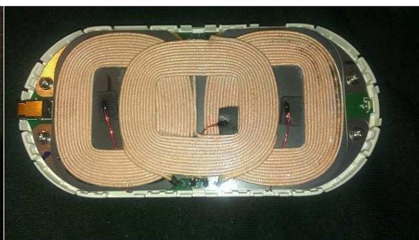
Figura 91: Bobinas de cobre
