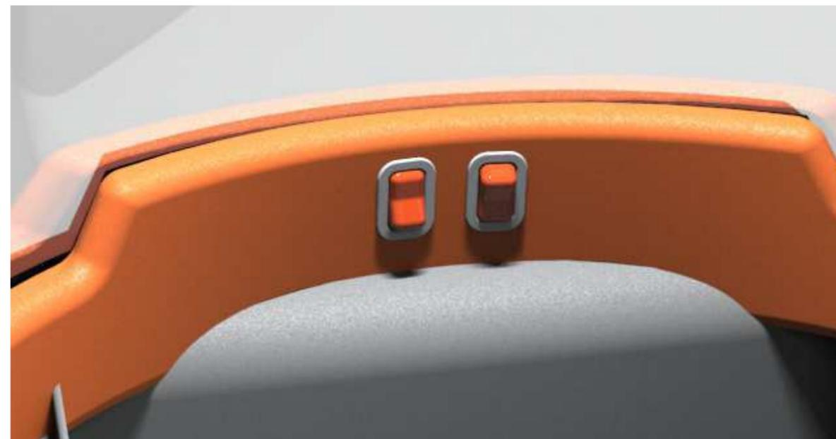
Figura 45. Botões da Lâmpada Interna e Farol da Cabine.
