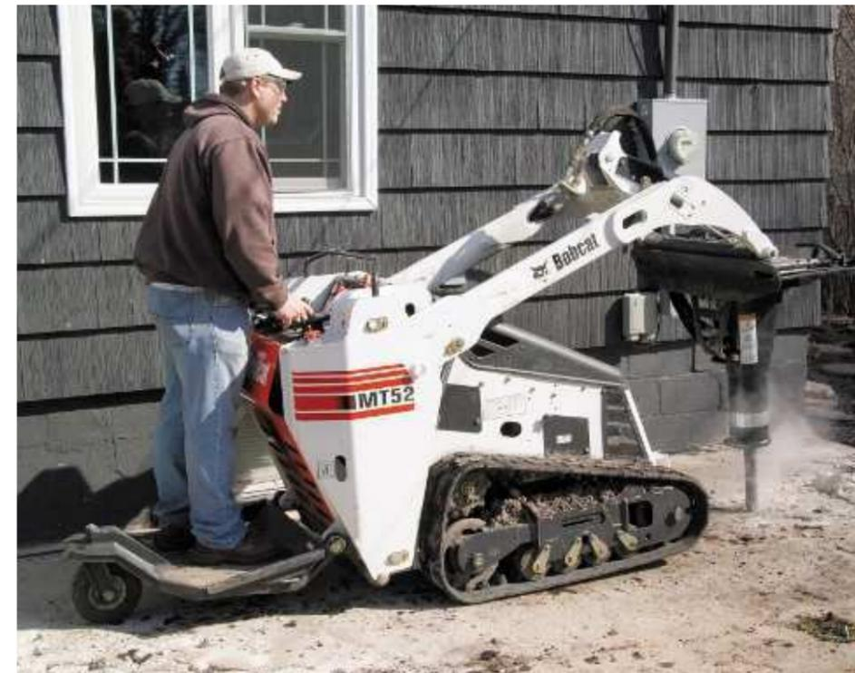
Figura 13. Mini-carregadeira MT52 com plataforma acoplada.
