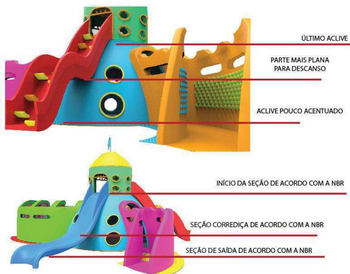
Figura 95 Dimensionamento dos elementos
