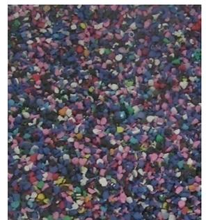
FIGURA 42: SBR peneirado e pronto para utilização.
