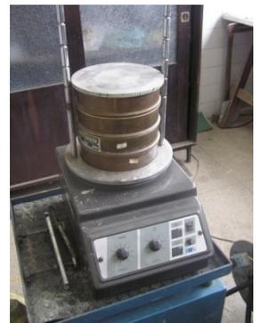
FIGURA 41: Máquina usada para peneirar o SBR.
