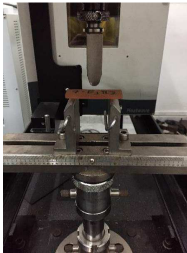
Figura 3.6 – Detalhe da máquina de ensaio de flexão em três pontos
