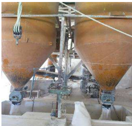
Figura 2.4 - a) Classificação pneumática do rejeito e diatomita calcinada; b) Rejeito descartado após processo final
