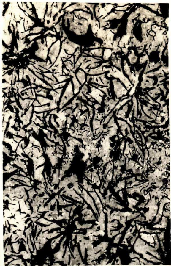
Fofo cinzento com veios de grafite tipo C.(Ampl.100x)
