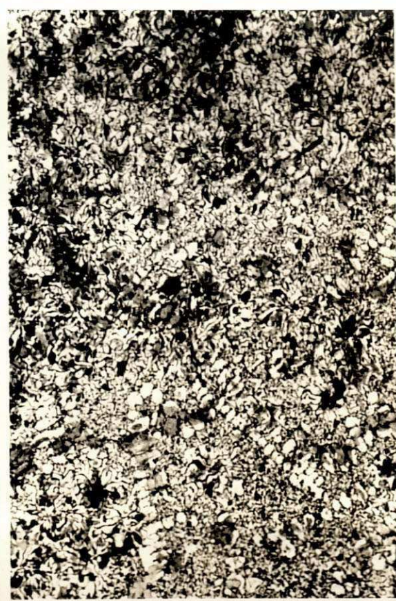
Fofo cinzento com veio tipo D. 60% ferrita, 40% perlita(100x)
