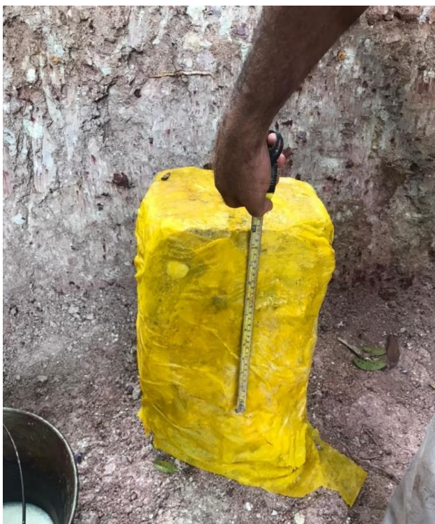
Figura 14. Coleta de amostra indeformada para ensaios geotécnicos em laboratório.
