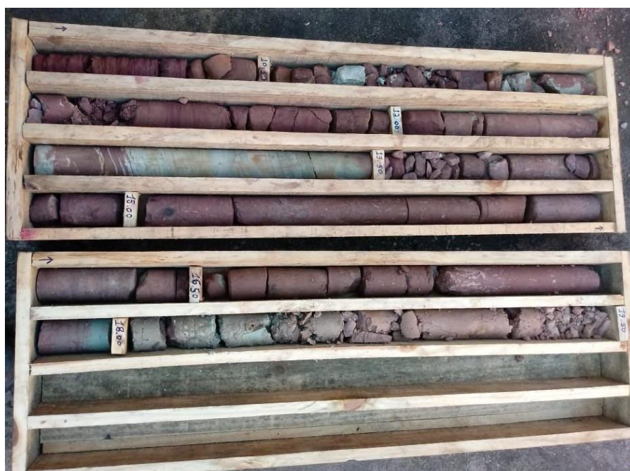
Figura 16. Caixa de testemunho de sondagem rotativa no Porto de Itaquí.
