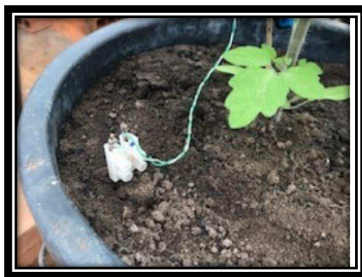
Figura 6 - Sensor de umidade do solo com haste de 10 cm, inserido no solo.
