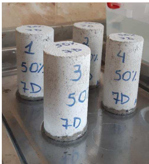
Figura 20: Corpos de prova com uma das faces em contato com a água por 72h.
