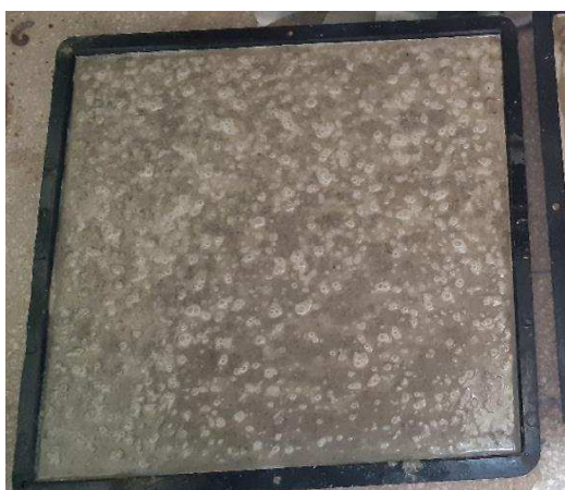
Figura 28: Presença de bolhas de ar na placa
