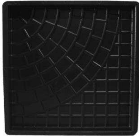
Figura 21: Molde utilizado para a formulação do protótipo (32cm x 32cm x 2,5cm)
