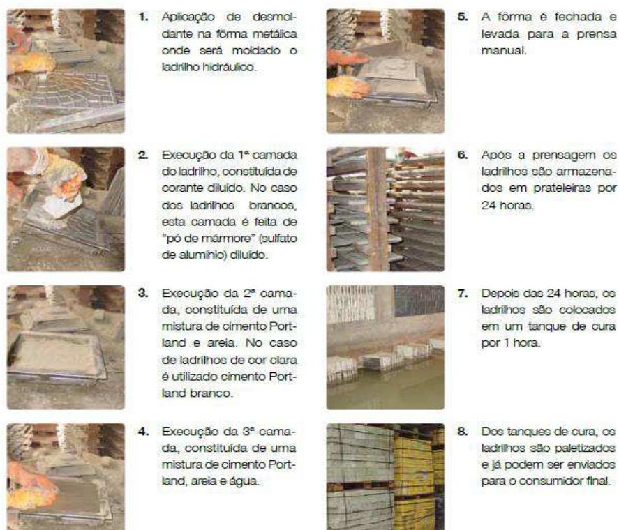
Figura 05: Sequência da fabricação do ladrilho hidráulico prensado
