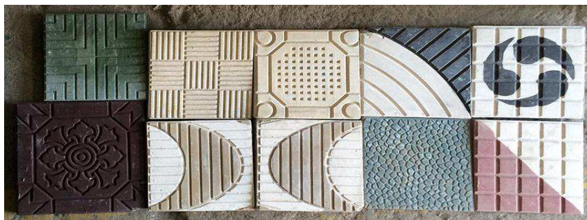
Figura 04: Exemplos de ladrilhos hidráulicos com texturas diversificadas e função antiderrapante.
