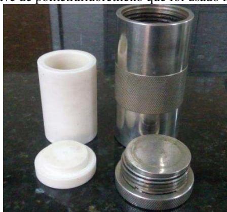
Figura 4 - Autoclave de politetrafluoretileno que foi usado na etapa de hidrólise
