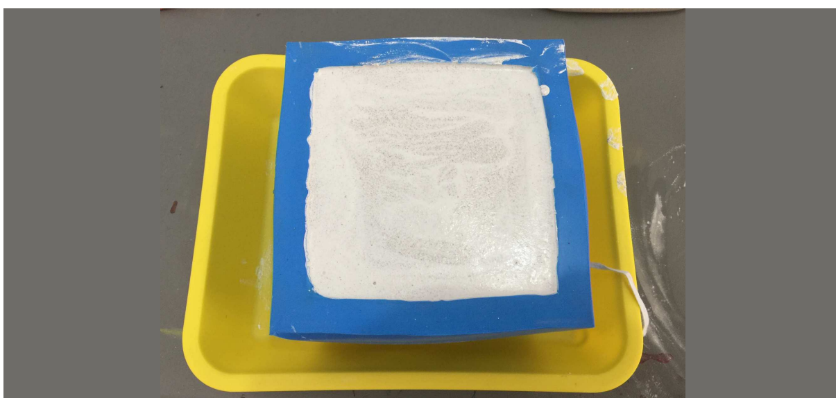
Figura 79 – Peça em MR sendo conformada no contra molde de silicone (acervo do autor, 2019).
