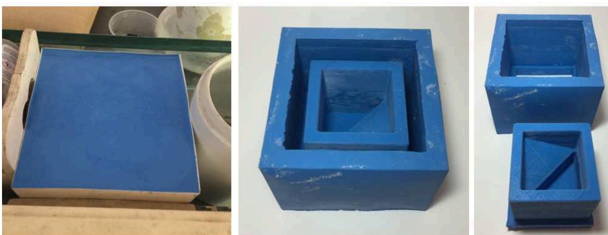
Figura 78– À esquerda: manufatura do Molde de Silicone; no centro: Molde de silicone pronto; à direita: Molde de silicone bipartido (acervo do autor, 2019).
