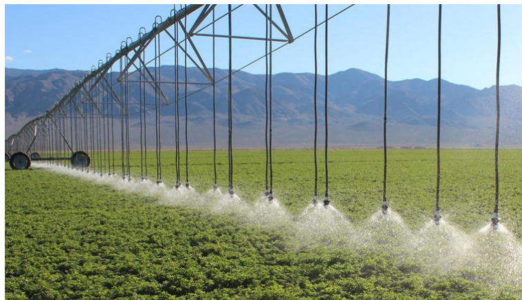
FIGURA 9: Sistema de irrigação do tipo LEPA
