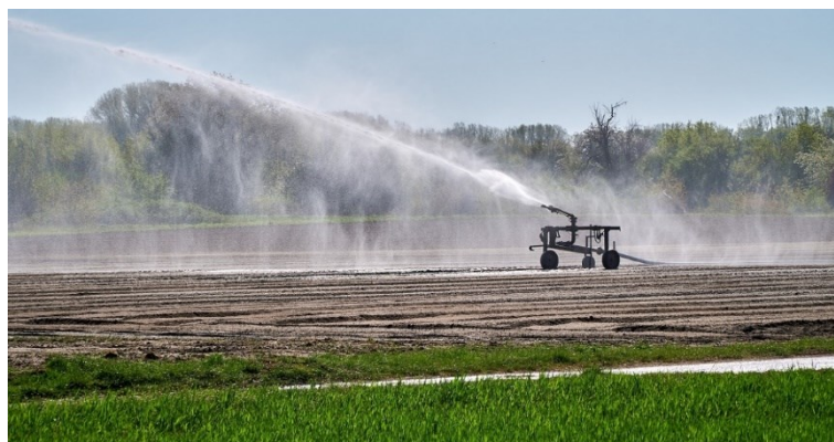
FIGURA 6: Sistema de irrigação autopropelido
