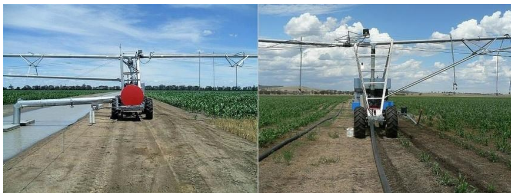
FIGURA 8: Sistema de irrigação por deslocamento linear.
