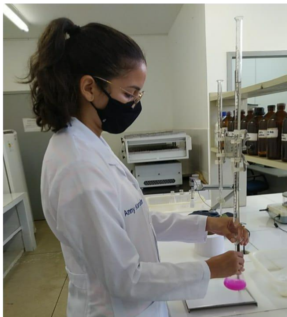
Figura 5: Titulação com solução de HCl 0,25 mol L -1
