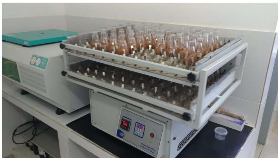
Figura 6: Agitação das amostras de solo irradiadas e não irradiadas + solução extratora.
