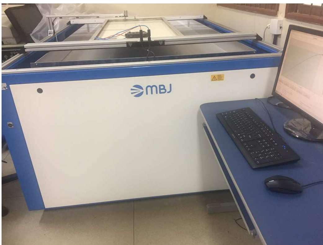
Figura 20 – Painel KYOCERA KC130TM conectado ao SolarModule LED-Flasher .
