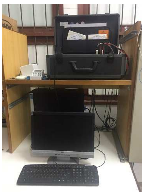
Figura 18 – Bancada de testes utilizada para medição e aquisição de dados dos painéis fotovoltaicos com o PROFITEST PV.
