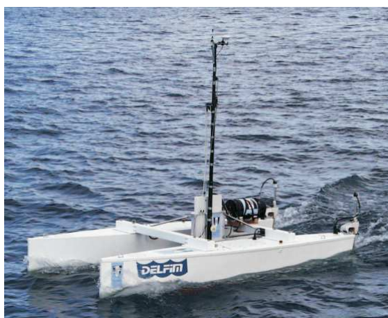
Figura 1.2: Embarcação de superfície: Projeto DELFIM. Fonte: Prado [11]
