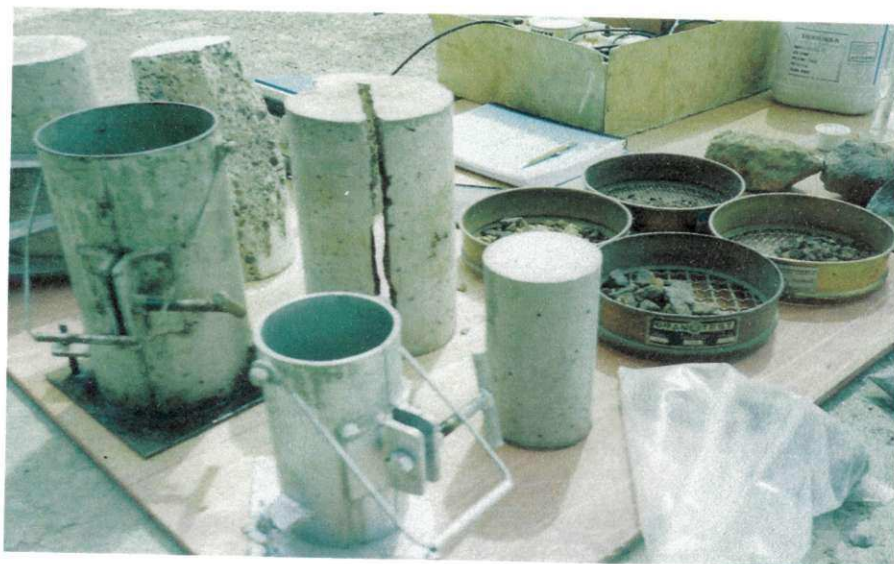
Figura 7.2 – Corpos-de-prova, moldes e peneiras utilizadas nos ensaios
