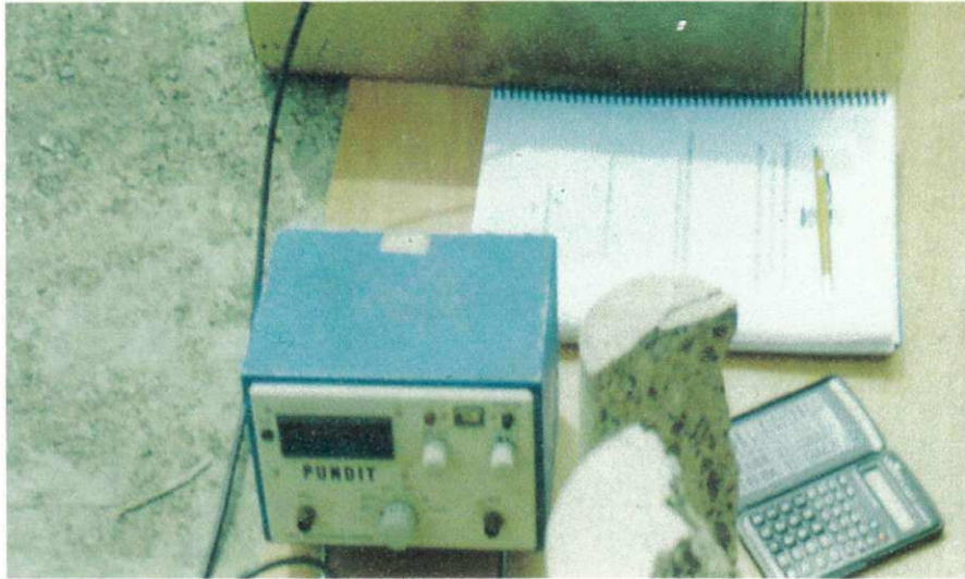
Figura 7.5 – PUNDIT utilizado na determinação do módulo de elasticidade
