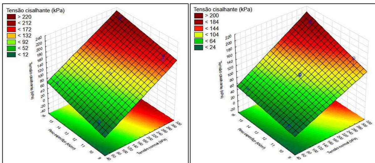
Figura 119 – Superfície resposta para tensão cisalhante dos resíduos com 2 anos de idade para a condição não inundada (a) e não inundada (b) em função da tensão normal e umidade, com peso específico fixado em  $12,5 \text{ kN/m}^3$
