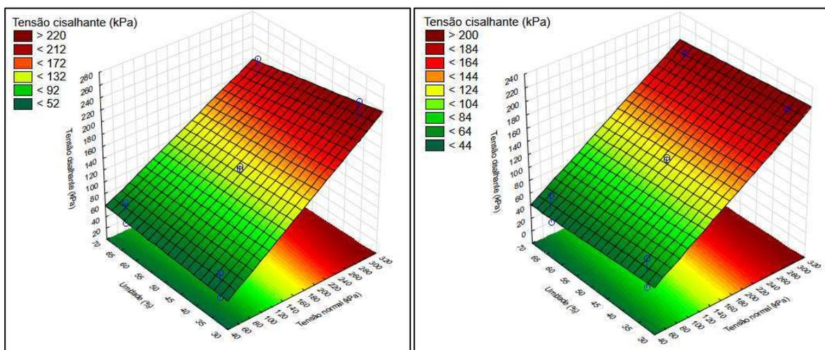
Figura 117 – Superfície resposta para tensão cisalhante dos resíduos com 1 ano de idade para a condição não inundada (a) e inundada (b) em função da umidade e peso específico, com tensão normal fixada em 175 kPa
