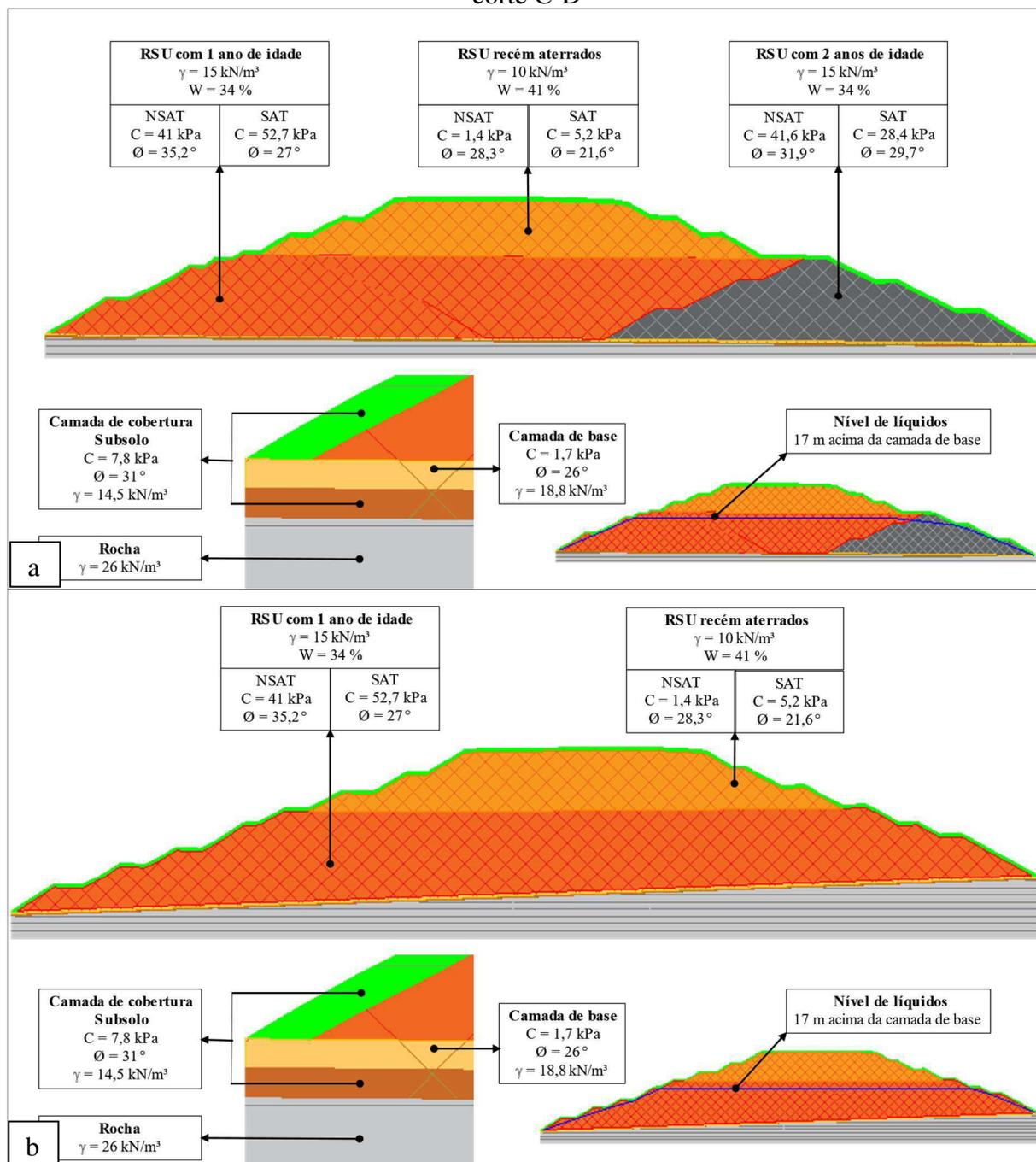
Verifica-se, na Figura 112, que os parâmetros de resistência em uma mesma seção apresentam uma amplitude de variação significativa. O intercepto coesivo, por exemplo, variou de 1,4 a 52,7 kPa. O ângulo de atrito variou de 21,6 a 35,2°. Devido aos processos de transformações que ocorrem nos resíduos, é esperado que estes parâmetros se alterem ao longo do tempo e estas mudanças devem ser consideradas na análise de estabilidade de taludes.
