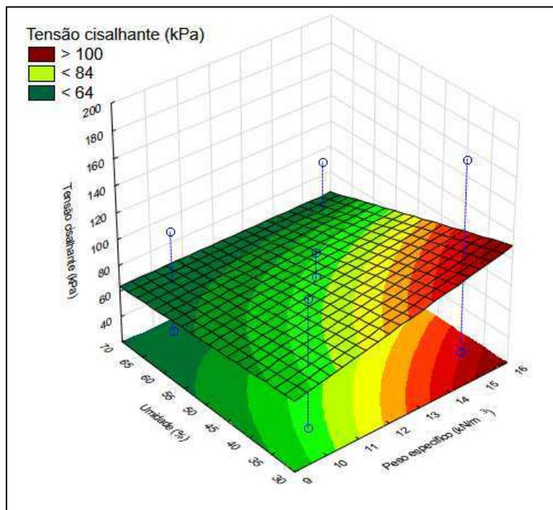
Nas superfícies resposta apresentadas nas Figuras 96 e 97 verifica-se que os maiores valores de tensão cisalhante acontecem sob maiores níveis de peso específico e menores níveis de umidade. De maneira análoga à superfície resposta apresentada nas Figuras 95 e 96, a variação dos níveis de peso específico influencia mais do que a variação do teor de umidade, embora que em menor intensidade, como é possível perceber pela inclinação dos planos das superfícies nas Figuras 96 e 97.
