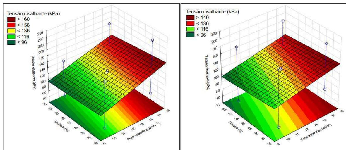
Figura 118 – Superfície resposta para tensão cisalhante dos resíduos com 2 anos de idade para a condição não inundada (a) e inundada (b) em função da tensão normal e peso específico, com umidade fixada em 49,5%
