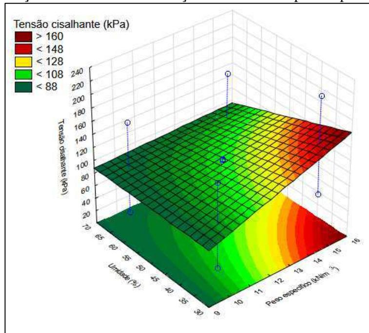
Figura 97 – Superfície resposta para tensão cisalhante dos resíduos recém aterrados para a condição inundada em função da umidade e peso específico
