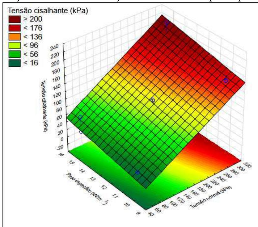
Figura 93 – Superfície resposta para tensão cisalhante dos resíduos recém aterrados para a condição inundada em função da tensão normal e peso específico
