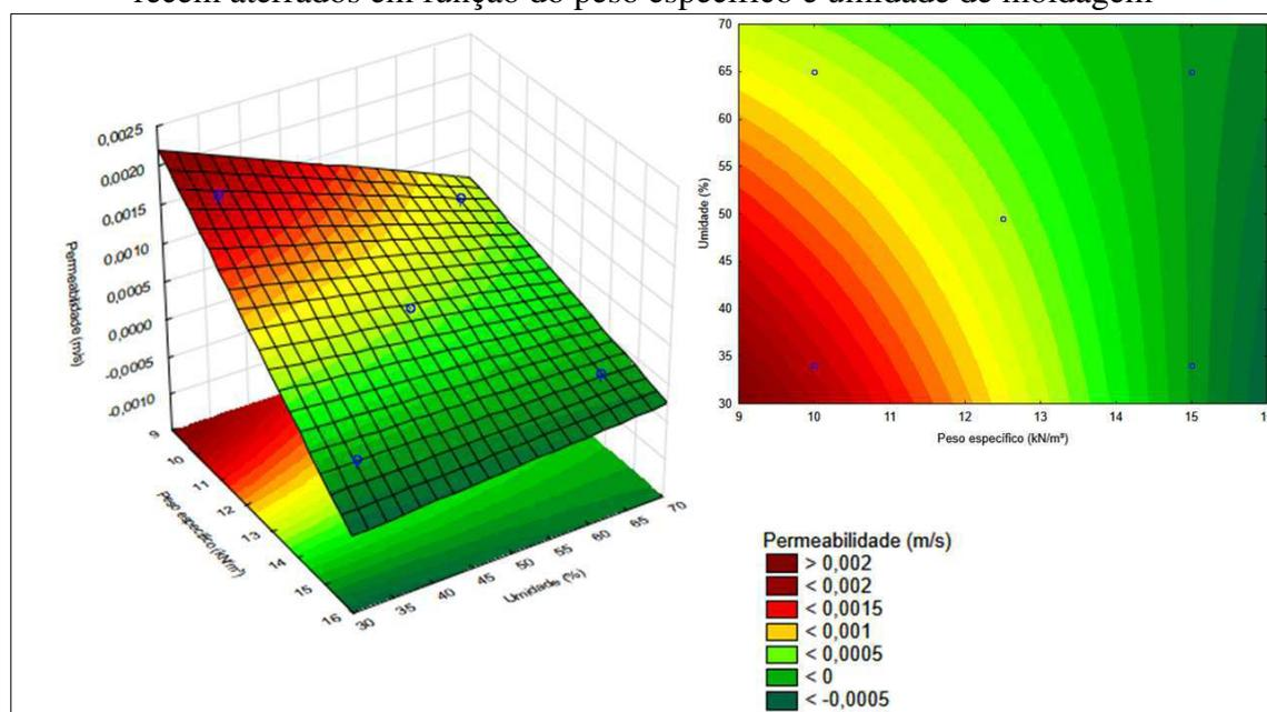
Conforme ilustrado na Figura 67, a menor permeabilidade à água dos resíduos recém aterrados foi obtida em amostras com maior peso específico ( $15 \text{ kN/m}^3$ ) e menor umidade de moldagem (34%). A maior permeabilidade foi verificada em resíduos recém aterrados com menor peso específico ( $10 \text{ kN/m}^3$ ) e menor umidade (34%). Ainda é possível constatar que resíduos com peso específico elevado, a variação da umidade de moldagem praticamente não altera a permeabilidade.
