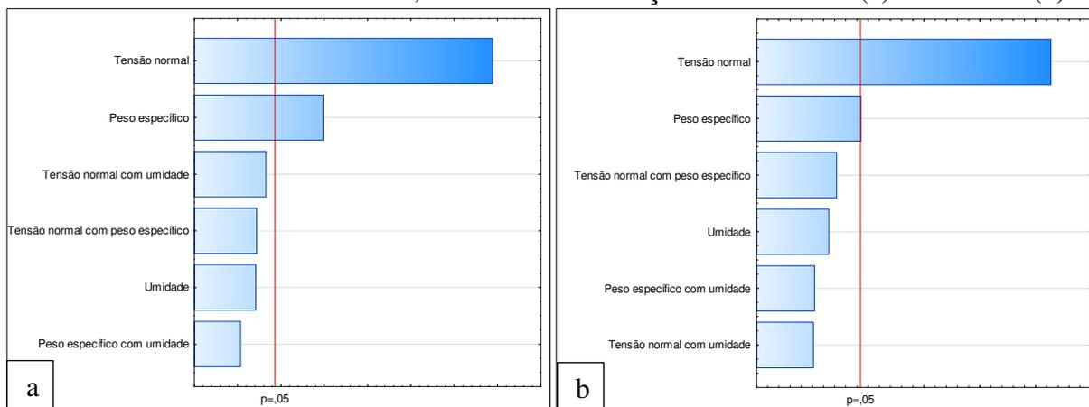
O gráfico de Pareto dos efeitos padronizados (Figura 91) indica, para um nível de significância de 5%, que a tensão normal, peso específico e a interação da umidade com peso específico exercem maior influência sobre os resultados de tensão cisalhante dos resíduos com 2 anos de aterrados para a condição não inundada.
