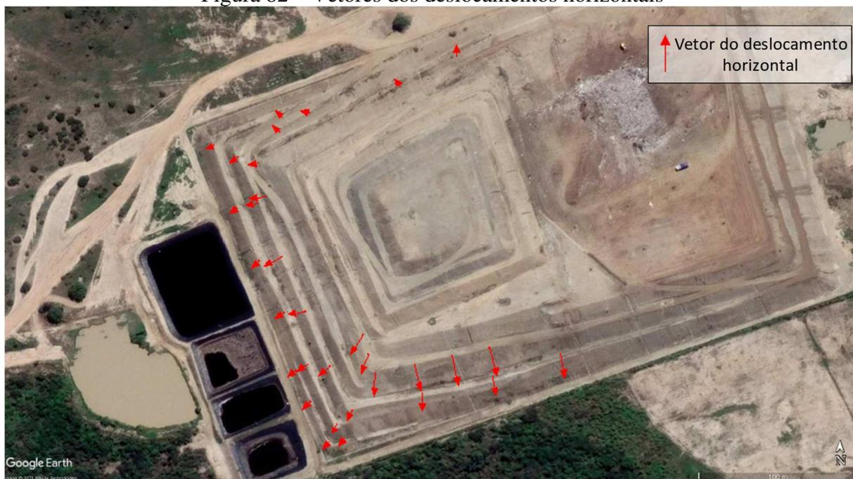
É importante observar na Figura 82 que o ASCG possui uma direção preferencial de movimentação, que coincide com o desnível do terreno no qual se assenta. Mesmo assim, os deslocamentos reais atingidos não foram uniformes. A direção dos deslocamentos horizontais é perpendicular ao centro do maciço, com sentido para as extremidades do ASCG. Este comportamento sugere um ajuste das inclinações dos taludes (1H:2V), para maior segurança da estabilidade maciço sanitário.
