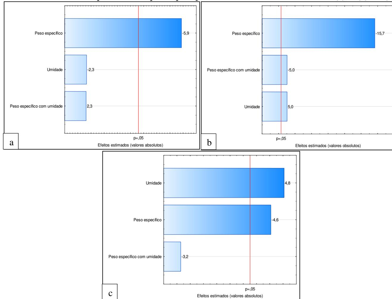
Conforme a Figura 66, o peso específico possui uma relação inversamente proporcional a permeabilidade à água dos resíduos com 0, 1 e 2 anos de aterrados. Analisando o efeito da umidade de moldagem na permeabilidade à água dos resíduos, observa-se uma relação inversamente proporcional nos resíduos recém aterrados e diretamente proporcional nos resíduos com 1 e 2 anos de aterrados. Estas relações podem, também, ser verificadas na Tabela 12, por meio do coeficiente de correlação de Pearson.
