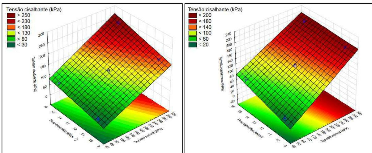
Figura 116 – Superfície resposta para tensão cisalhante dos resíduos com 1 ano de idade para a condição não inundada (a) e não inundada (b) em função da tensão normal e umidade, com peso específico fixado em 12,5 kN/m<sup>3</sup>
