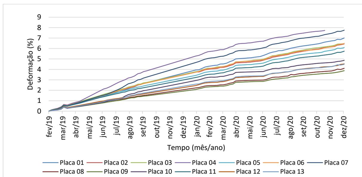
De forma geral, observa-se na Figura 79 que as deformações específicas monitoradas no ASCG possuem um comportamento semelhante, assim como a magnitude e velocidade dos recalques. O aumento das deformações foi diretamente proporcional ao tempo de aterramento e, durante os 672 dias de monitoramento, não há indicativo de estabilização das deformações.
