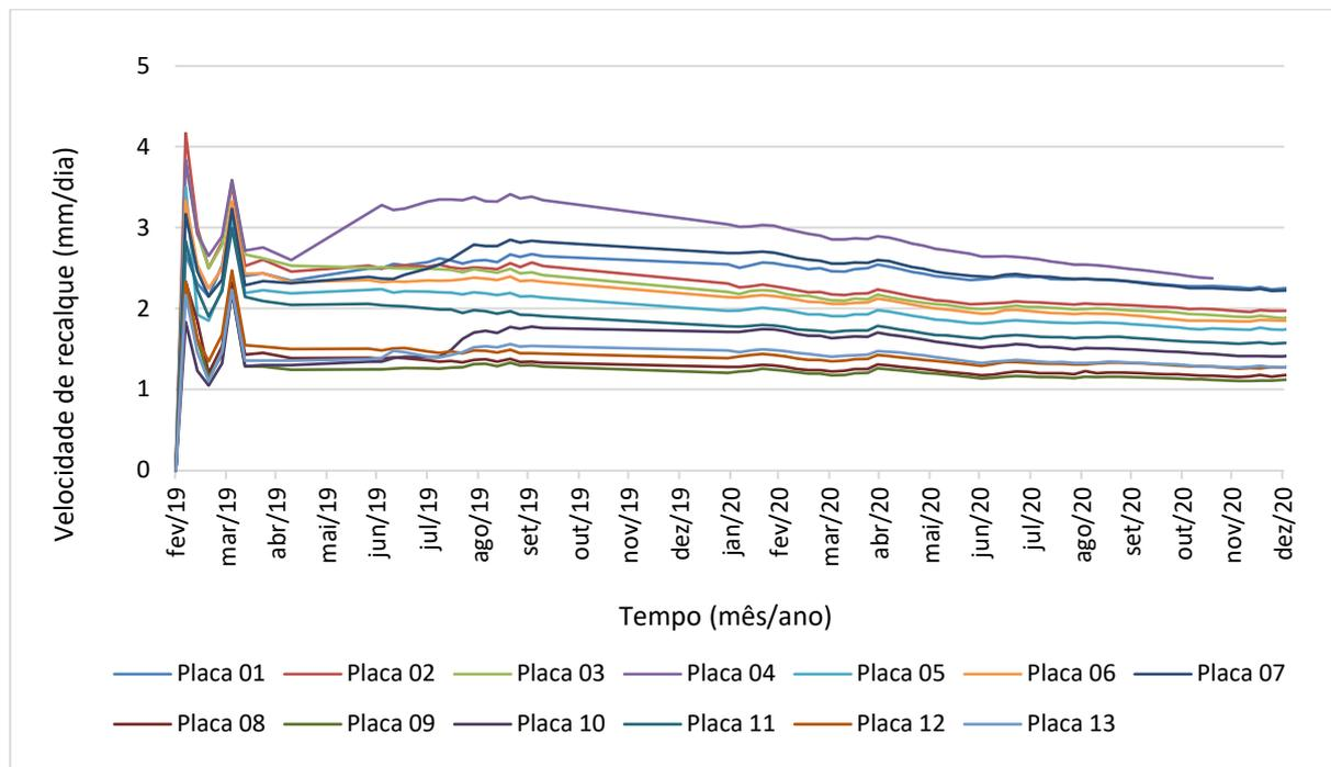
Verifica-se na Figura 78, que no período inicial do monitoramento, as velocidades dos recalques variaram de 4,2 a 1,8 mm/dia. No término do monitoramento houve uma redução dessas velocidades para valores variando entre 2,1 e 1,1 mm/dia.
