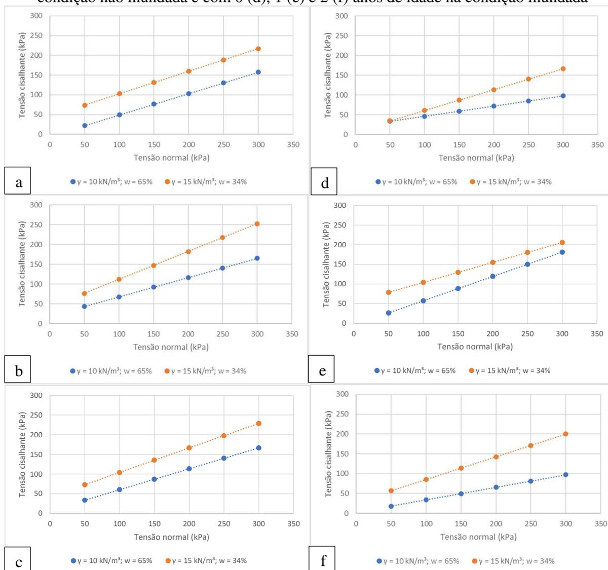
Verifica-se na Figura 102 que a inundação dos corpos de prova diminuiu as tensões cisalhantes das amostras, reduzindo, portanto, a influência que o peso específico exerce na resistência ao cisalhamento, como pode ser observado na Tabela 27.
