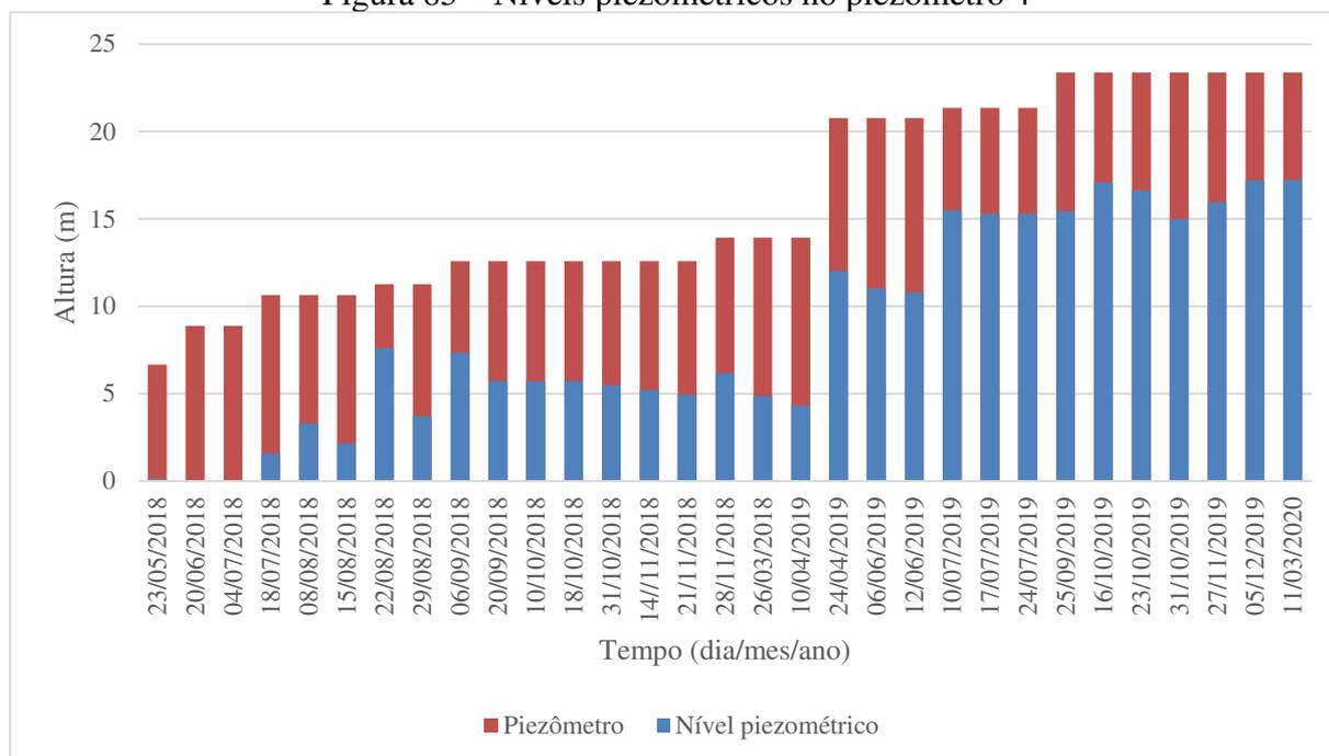
Durante o período de monitoramento os níveis piezométricos ultrapassaram o limite estabelecido pela NBR 13896 (ABNT, 1997), conforme ilustra as Figuras 83, 84 e 85. Para Bonaparte *et al.* (2020) o acúmulo de lixiviado em aterros sanitários pode reduzir os fatores de segurança de estabilidade de taludes e contribuir para o desenvolvimento de condições de taludes instáveis.
