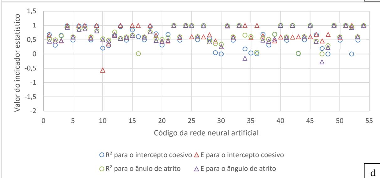
Na Figura 104 é possível observar que várias RNA possuem um bom desempenho para determinação da tensão cisalhante, intercepto coesivo e ângulo de atrito dos resíduos, pois apresentaram coeficiente de determinação e de eficiência próximo ou igual a 1.
