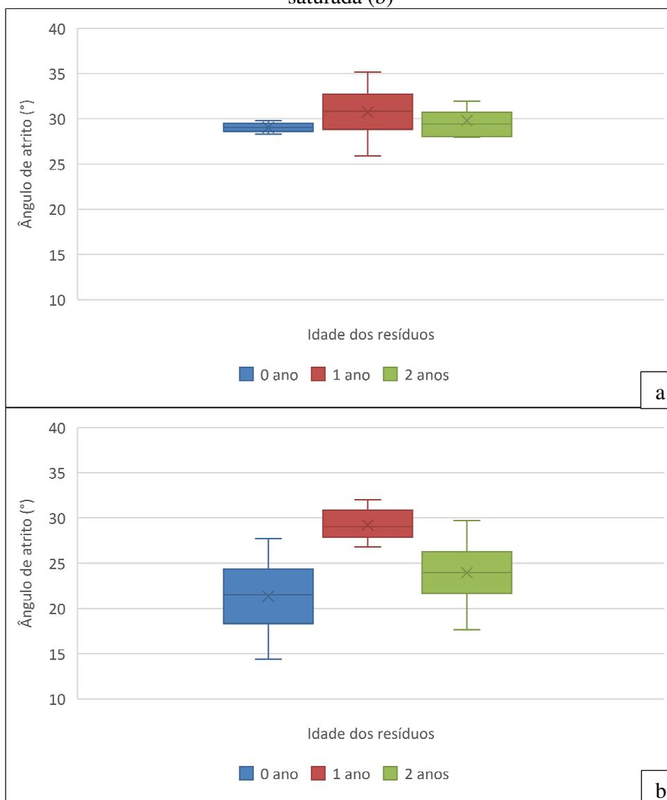
Observa-se na Figura 101 que os ângulos de atrito dos RSU possuem um comportamento semelhante ao intercepto coesivo dos resíduos. Na condição não saturada (Figura 101a), verifica-se um aumento deste parâmetro nos resíduos recém aterrados para o primeiro ano de aterramento. Já, nos RSU com 2 anos de aterrados os valores dos ângulos de atrito se aproximaram dos verificados nos resíduos recém aterrados.
