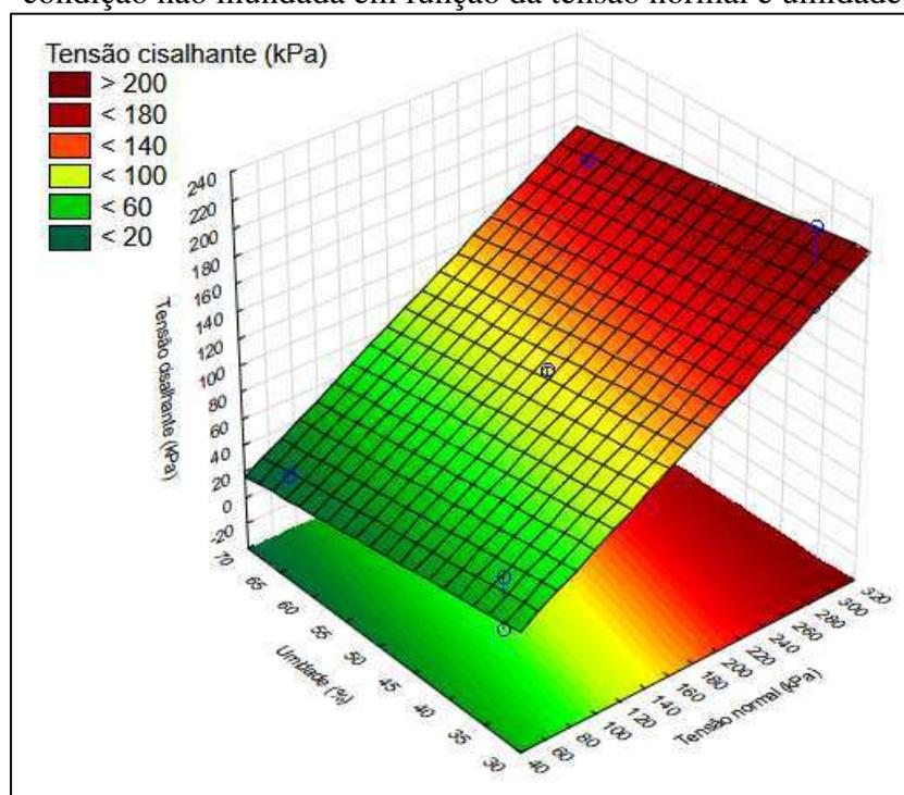
Figura 95 – Superfície resposta para tensão cisalhante dos resíduos recém aterrados para a condição inundada em função da tensão normal e umidade
