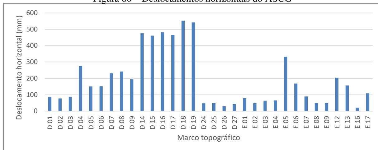
De modo geral, não há um deslocamento horizontal homogêneo no aterro sanitário, em termos de magnitude. Foram registrados valores variando de 20 a 552 mm. Esse fenômeno é
