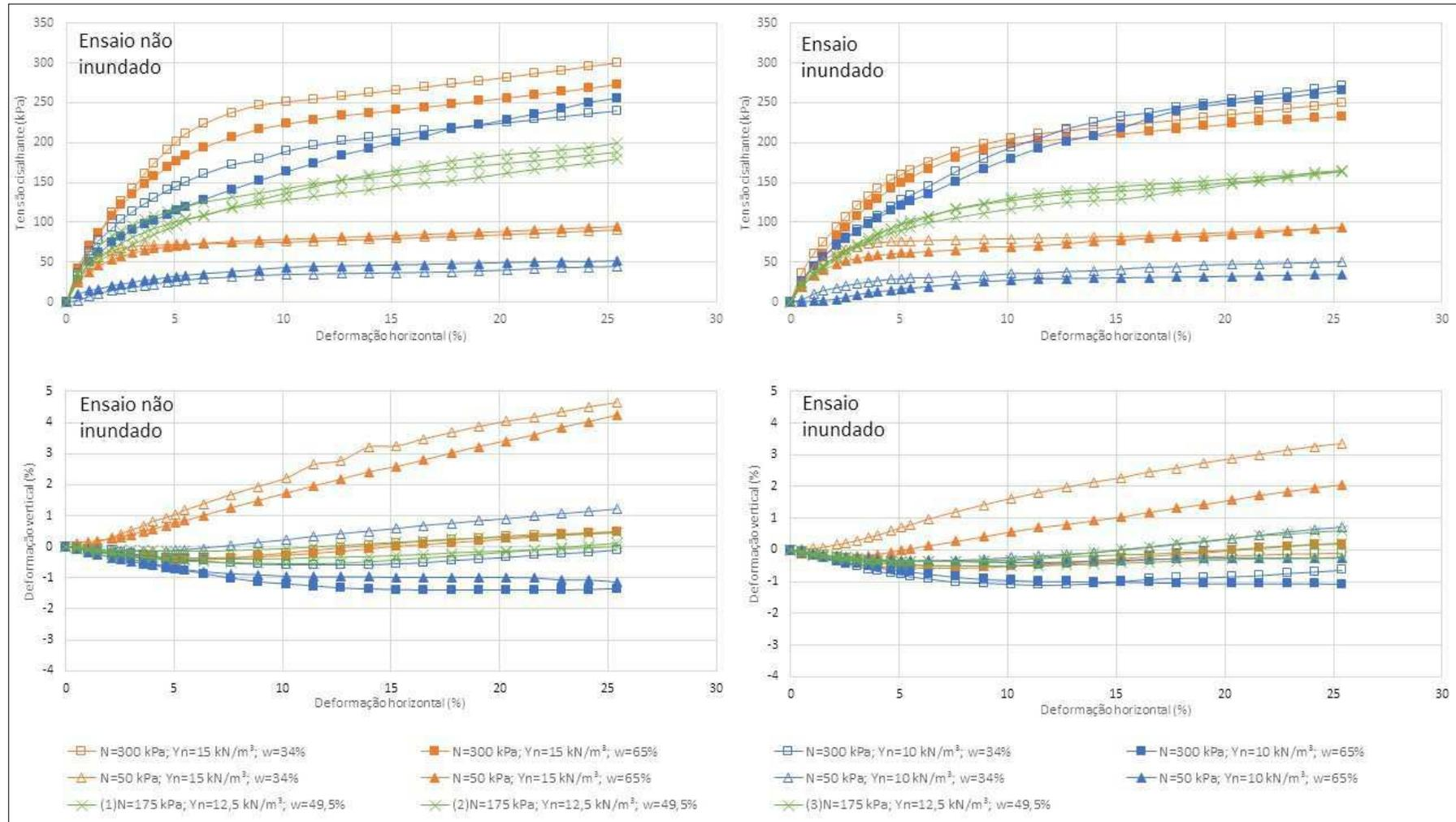
As curvas tensão cisalhante *versus* deformação horizontal e deformação vertical *versus* deformação horizontal (Figura 71) possuem comportamento análogo as curvas do resultado dos ensaios de cisalhamento direto apresentados na Figura 70. Porém, verifica-se que as tensões cisalhantes obtidas no término dos ensaios dos resíduos com 1 ano de aterramento, possuem valores superiores, indicando que, durante o período de 1 ano de aterramento dos resíduos há um aumento da resistência ao cisalhamento.
