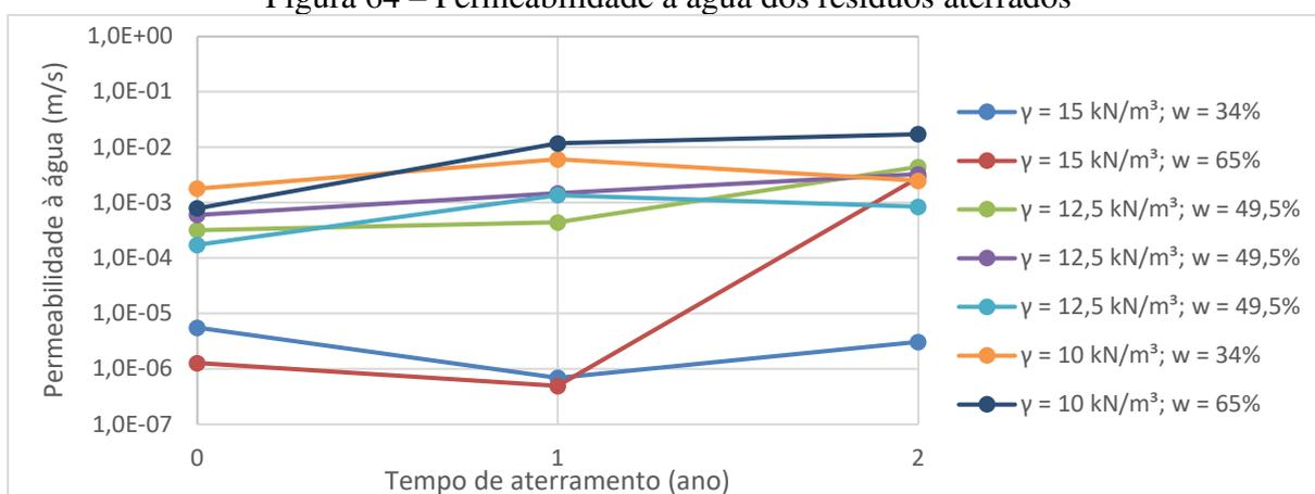
A permeabilidade à água dos resíduos aterrados (Figura 64) variou de  $5 \times 10^{-7}$  a  $1,7 \times 10^{-2}$  m/s. A menor permeabilidade foi verificada nos resíduos com maior peso específico ( $15 \text{ kN/m}^3$ ), maior umidade de moldagem (65%) e com 1 ano de aterrado. Já a maior permeabilidade foi verificada nos resíduos com menor peso específico ( $10 \text{ kN/m}^3$ ), maior umidade de moldagem (65%) e com 2 anos de aterrados.
