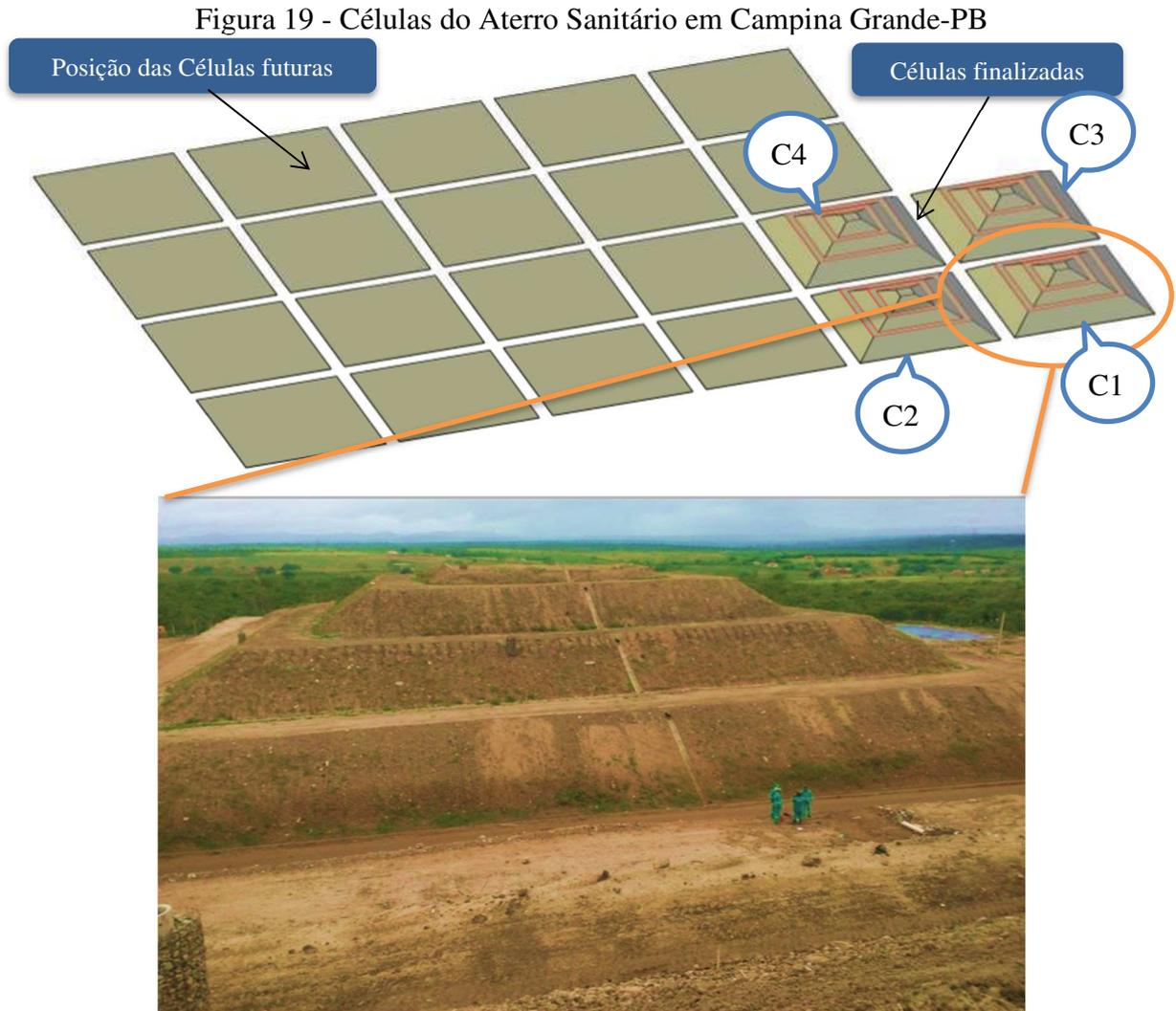
Desde o início da operação do ASCG, julho de 2015 até agosto de 2019, foram implantadas 4 Células, denominadas de Células 1 (C1), 2 (C2), 3 (C3) e 4 (C4). Além disso, foram também dispostos RSU entre as Células 1, 2, 3 e 4 com o intuito de unificá-las, formando uma única Célula de dimensões 225 x 225 m, conforme esquematizado na Figura 20.
