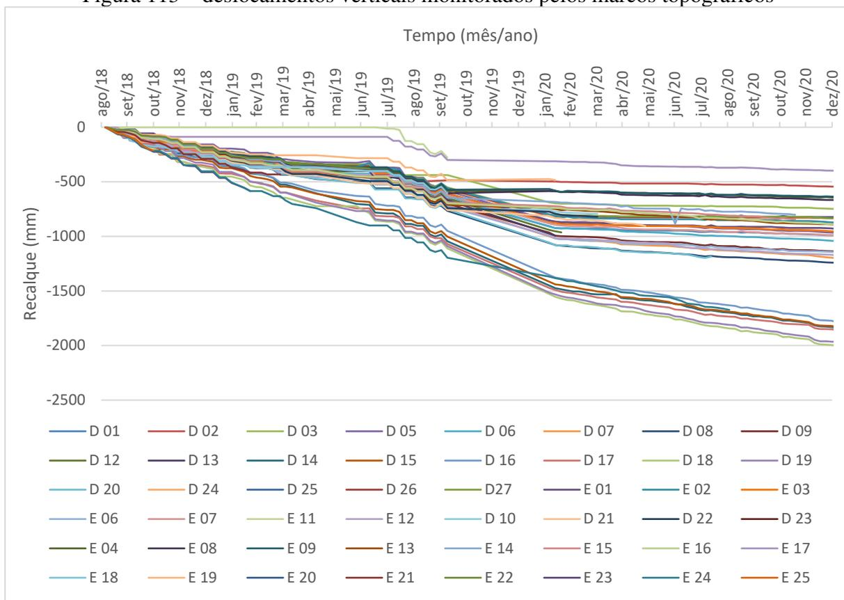
Figura 114 – Velocidades dos deslocamentos verticais monitorados pelos marcos topográficos
