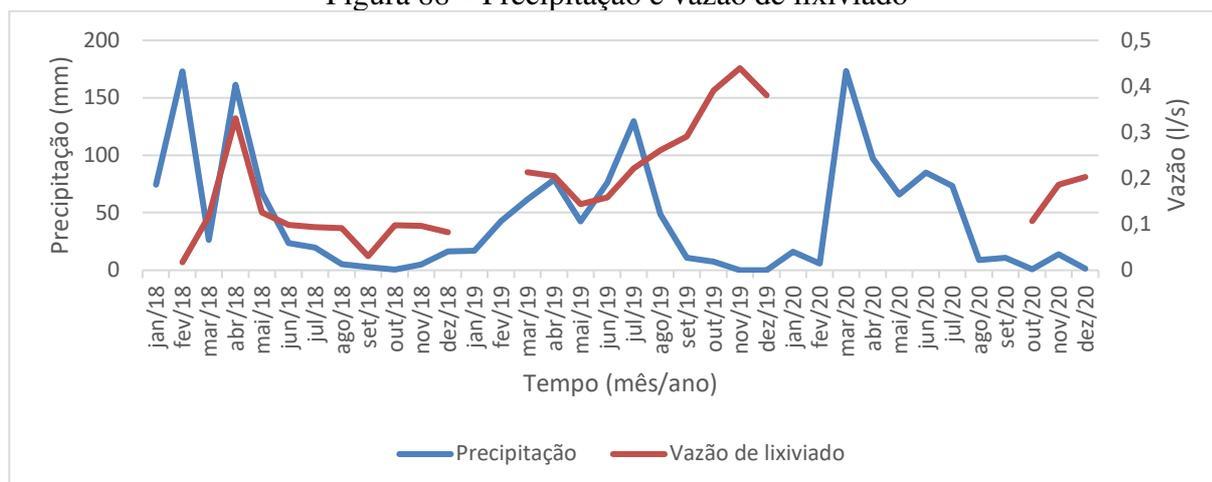
Verifica-se, na Figura 88, que durante o período de monitoramento, o ASCG possuiu uma vazão de lixiviado média de 0,19 l/s, máxima de 0,44 l/s e mínima de 0,02 l/s. Estes valores são inferiores aos verificados por Rocha (2005) e Araújo *et al.* (2020). Rocha (2005) aferiu vazões entre 0,78 e 11,2 l/s no Aterro da Muribeca, região metropolitana do Recife, e Araújo *et al.* (2020) encontrou vazões superiores a 7 l/s no Aterro de Maceió.
