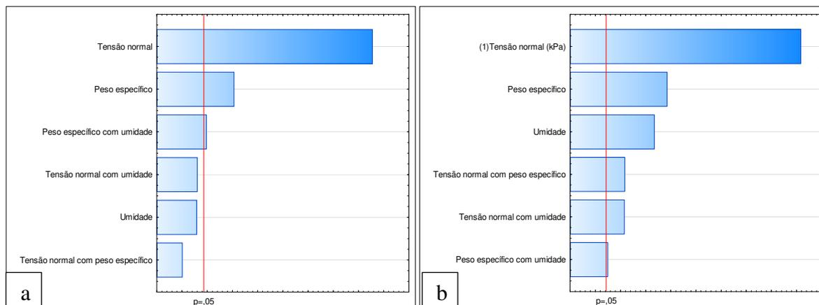
Para a condição inunda, Figura 91b, é possível constatar que todos os fatores têm influência no processo, sendo que a tensão normal, peso específico e umidade exercem, isoladamente, maior influência na tensão cisalhante para o modelo obtido. É possível dizer que todos os fatores são significativos para o processo, com efeito menos expressivo para a interação entre o peso específico e a umidade dos resíduos com 2 anos de idade.
