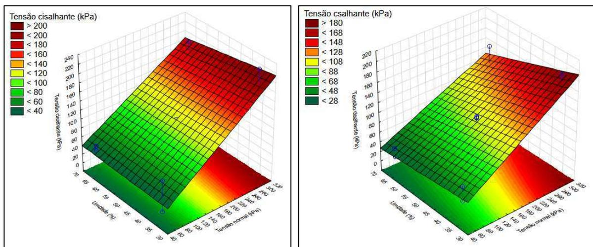
Figura 120 – Superfície resposta para tensão cisalhante dos resíduos com 2 anos de idade para a condição não inundada (a) e inundada (b) em função da umidade e peso específico, com tensão normal fixada em  $175 \text{ kPa}$
