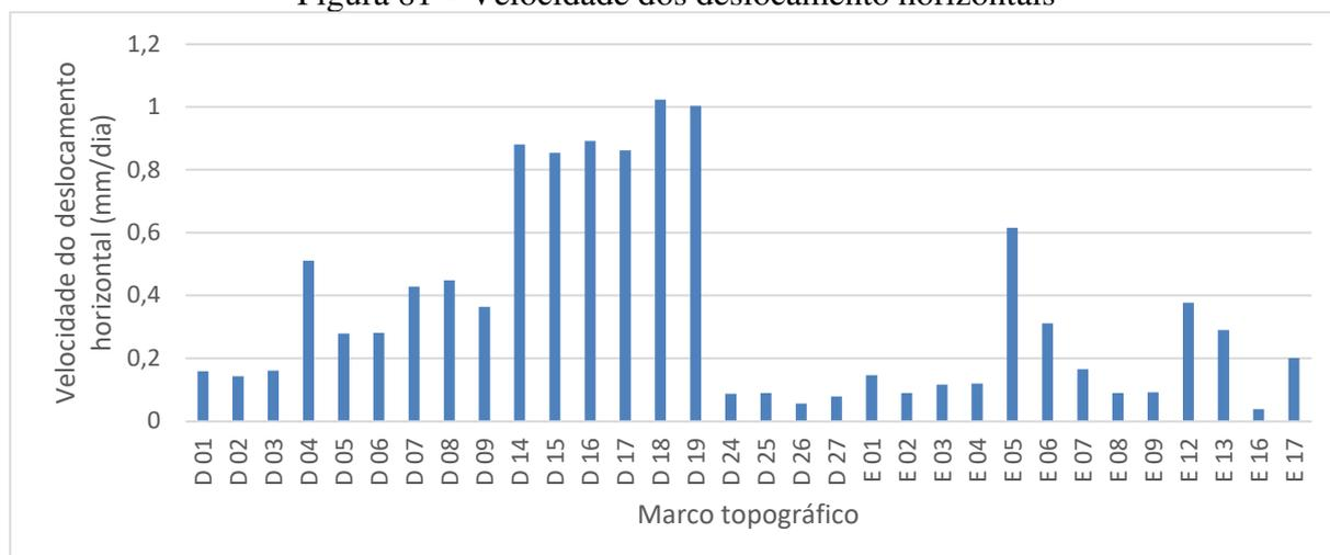
Como não existem normas com valores de referência para deslocamentos horizontais em aterros sanitários, pode-se utilizar a classificação do grau de risco em função sugerida por Oliveira (1996) e/ou Grassi (2005). Observa-se na Figura 81 que as velocidades dos deslocamentos horizontais estão próximas ou inferiores a 1 mm/dia, sendo classificadas com aceitável.
