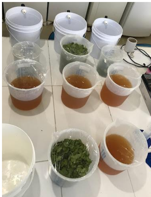
Figura 5: Biorreatores utilizados na fermentação alcoólica contendo suas respectivas concentrações de folhas e suco.
