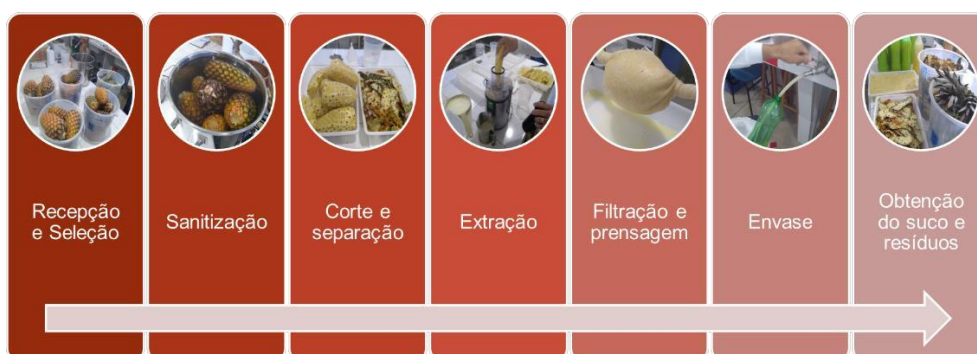
Figura 3: Fluxograma de obtenção do suco de abacaxi.
