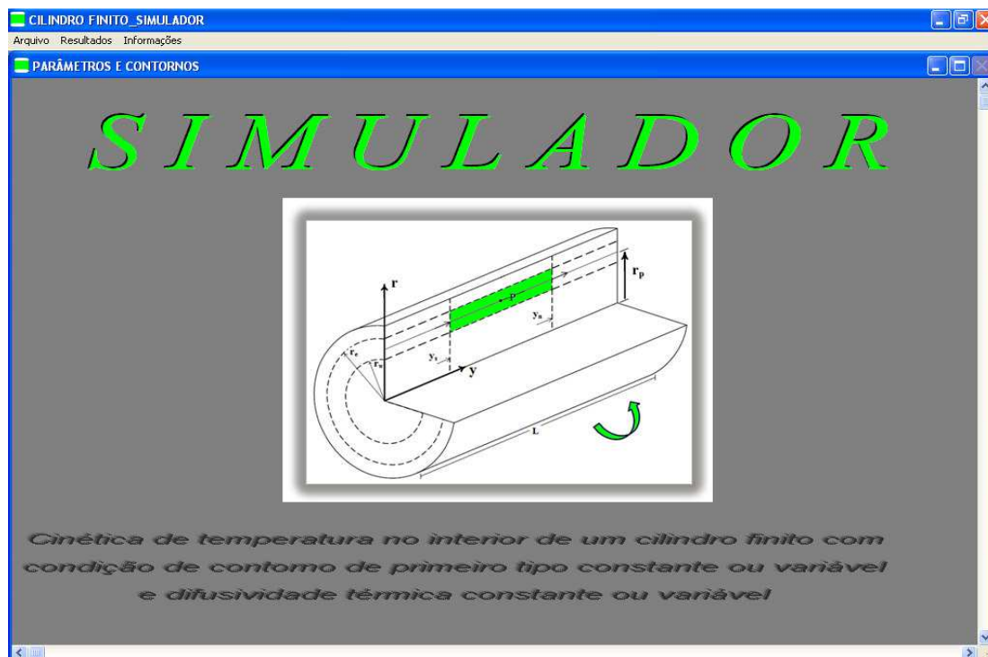
Figura 4.1 – Tela principal do software Simulador desenvolvido para simular a transferência de calor com condição de contorno do primeiro tipo e difusividade térmica aparente, constantes ou variáveis.
