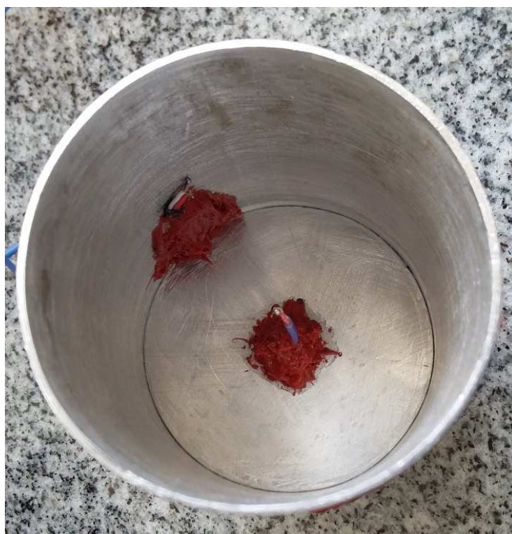
Figura 3.20 – Posicionamento dos termopares no recipiente.
