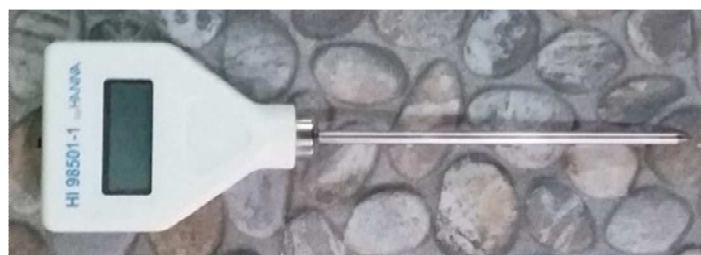
Figura 3.27 – Termômetro digital de espeto, modelo HI 98501-1 da HANNA.
