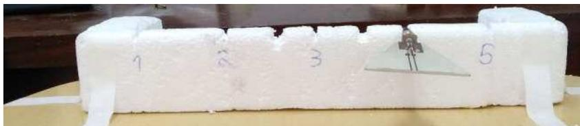
Figura 39. Posições Assumidas pela Antena para constituir o arranjo virtual (VULA)
