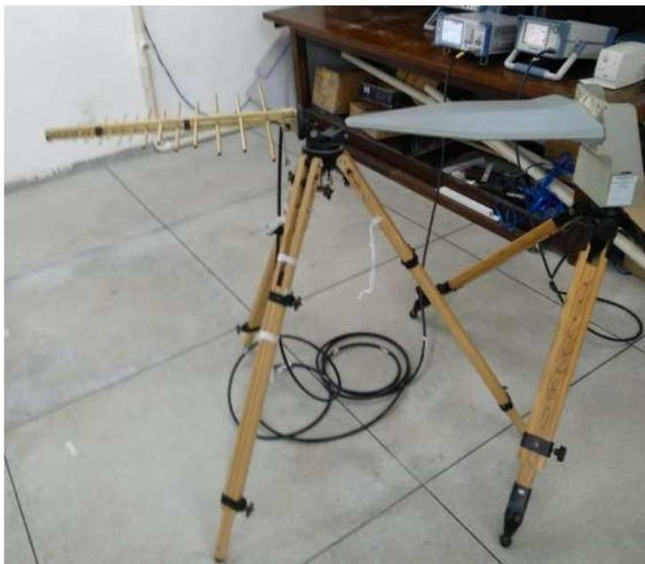
**Figura 40. Antenas Log-Periódicas e Geradores Utilizados como Fonte nos Experimentos**
