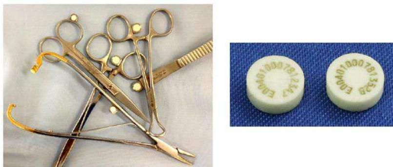
Figura 2-1 - Etiquetas cerâmicas aplicadas em instrumentais cirúrgicos [12].
