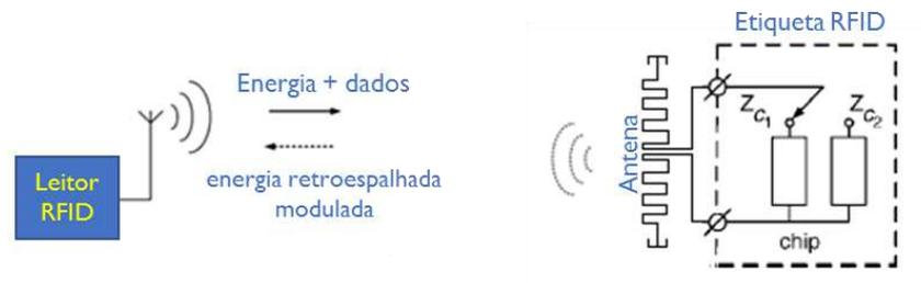
Figura 2-14 – Funcionamento do sistema RFID UHF. O sinal retroespalhado é modulado por variações na impedância  $Z_C$  do chip da etiqueta. Fonte: Autor.
