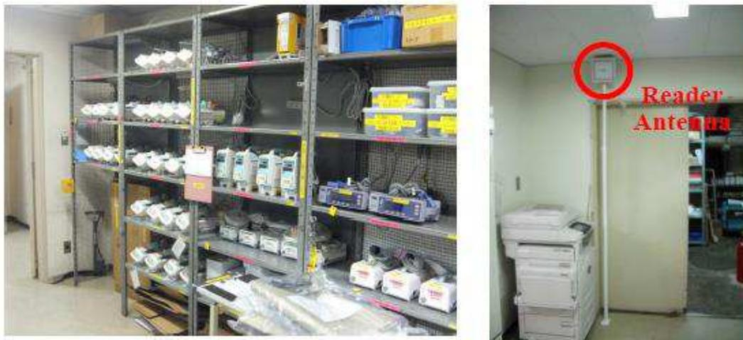
Figura 2-2 - Monitoramento de equipamentos médicos utilizando sistema RFID UHF. Fonte [14].
