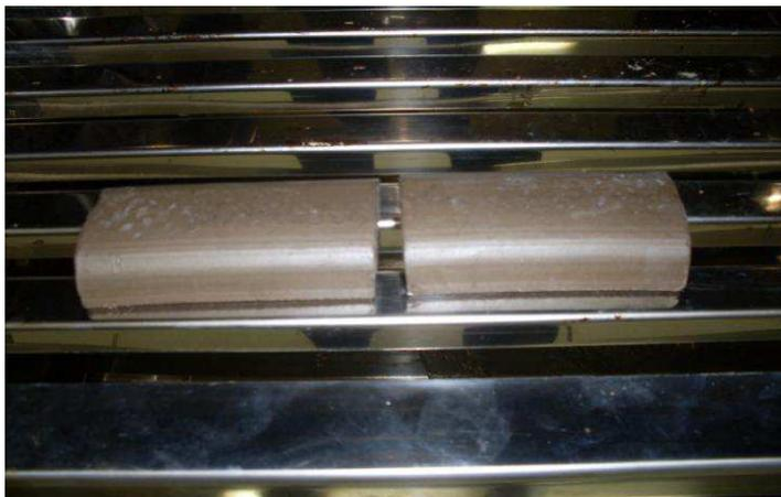
Figura 3.17 – Disposição das telhas no interior da estufa.
