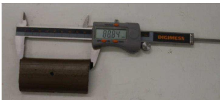
Figura 3.16 – Medindo o comprimento da telha.
