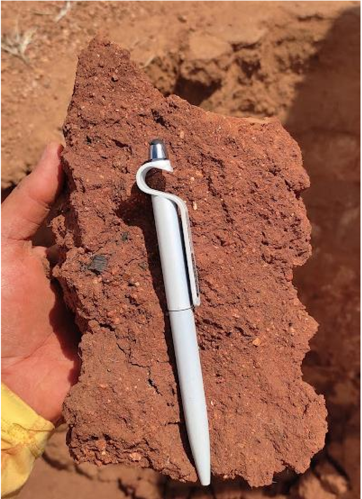
FIGURA 13. Estrutura prismática do horizonte Bt 1 . Fonte: Regis, 2022.
