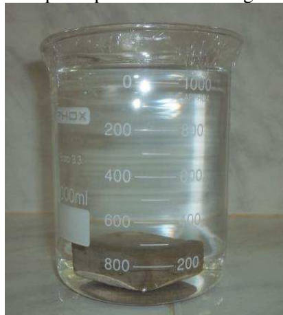
Figura 12: Corpo de prova imerso em água deionizada
