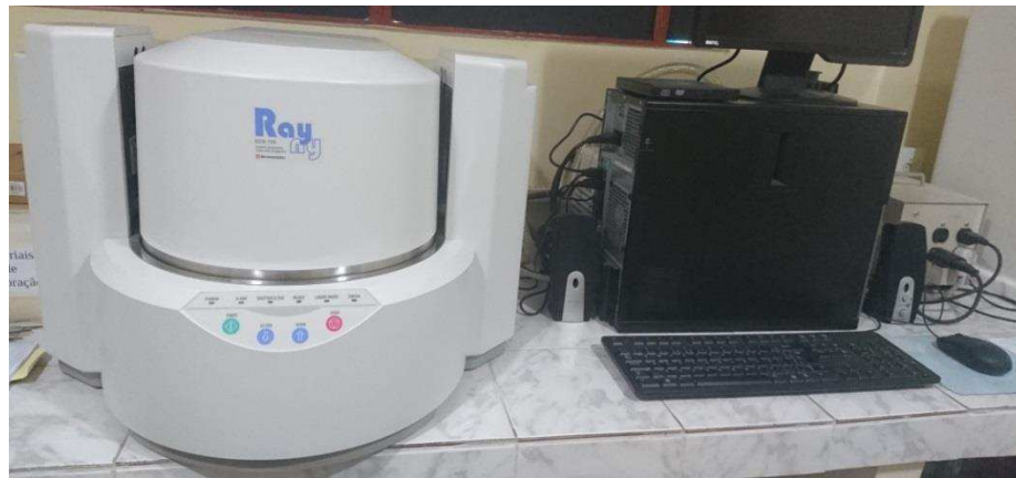
Figura 14 - Espectrômetro de energia dispersiva de raios-x da Shimadzu.
