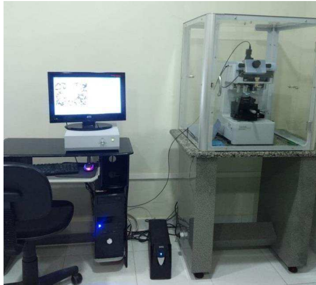
Figura 15 - Ultra-microdurômetro da marca Shimadzu modelo DUH-211.
