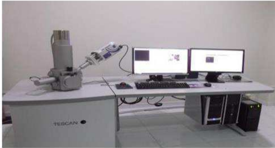
Figura 20 - Microscópio eletrônico de varredura Shimadzu Tescan VEGA3.
