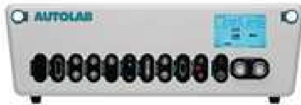
Figura 17 - Potenciostato Autolab PG STATE 302 N.
