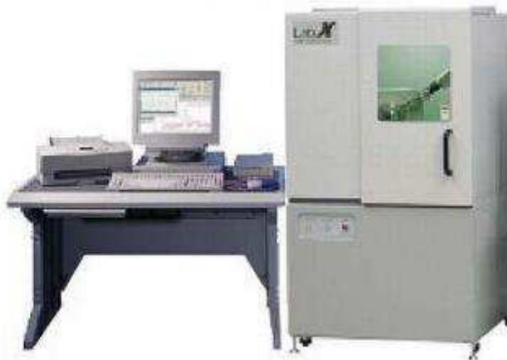
Figura 19 - Difratorômetro de raios-x modelo XDR-6100 da Shimadzu.
