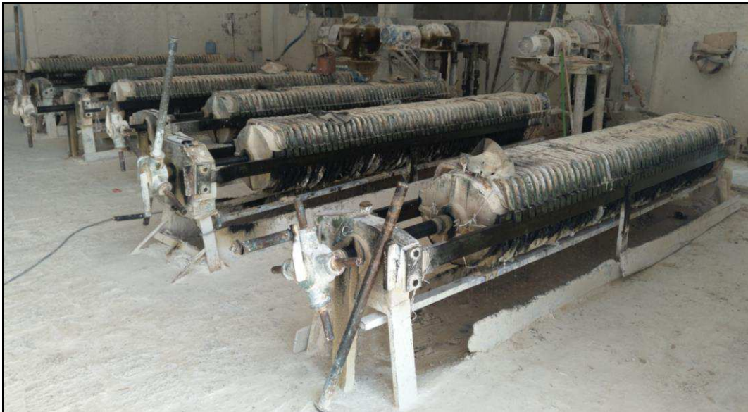
Figura 9: Circuito de prensas a vácuo utilizadas no processamento do caulim na empresa Caulise Caulim do Seridó Equador/RN.
