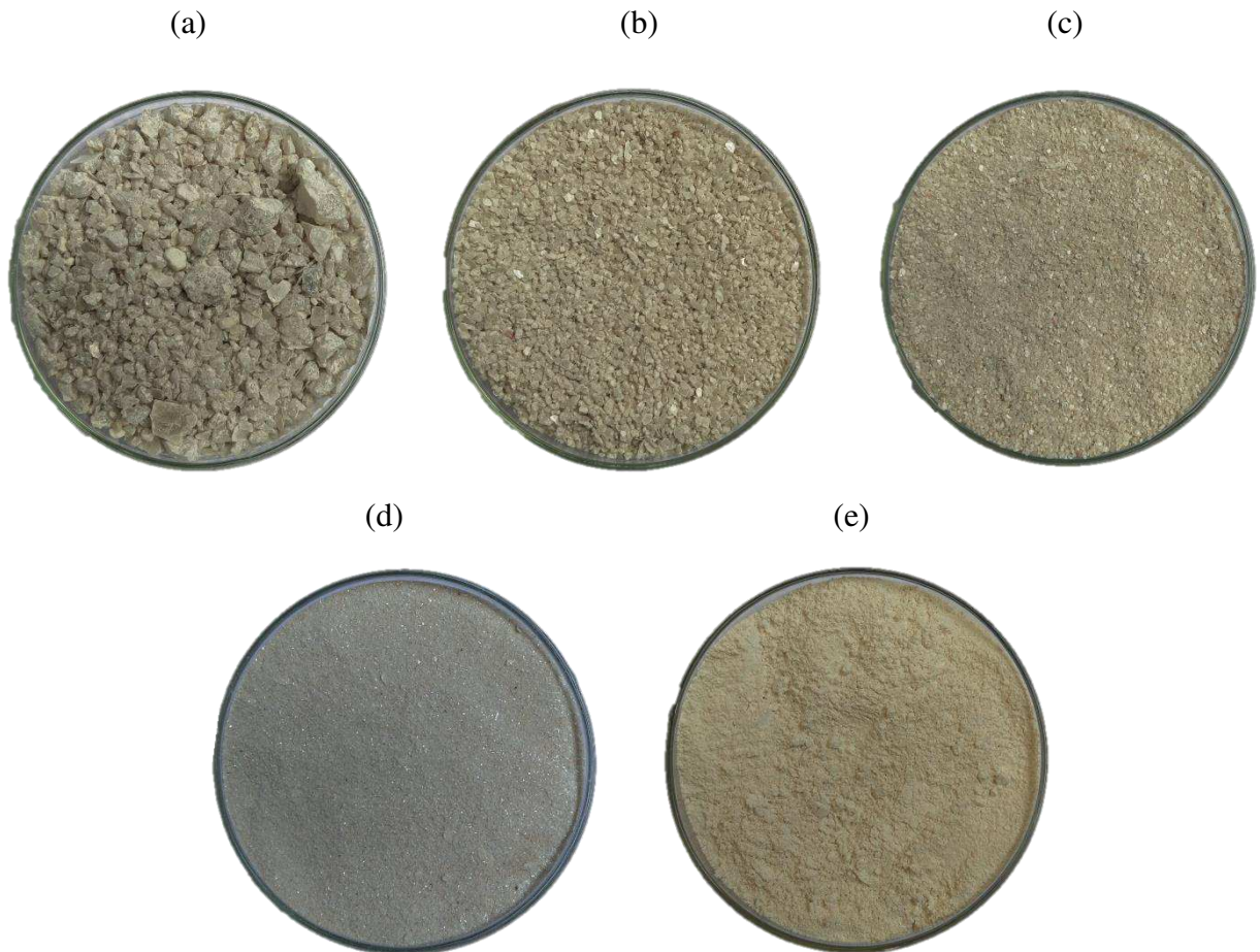
Figura 15: Ensaio de beneficiamento para a amostra de rejeito Sarrabulho PB a seco: (a) retido na peneira #09, (b) retido na peneira #14 e (c) retido na peneira #35; a úmido: (d) retido na peneira #325; e (e) passante na peneira #325.
