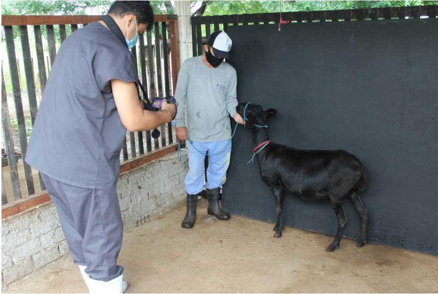
Figura 13: Coleta de imagem termográfica com anteparo de madeira ao fundo.
