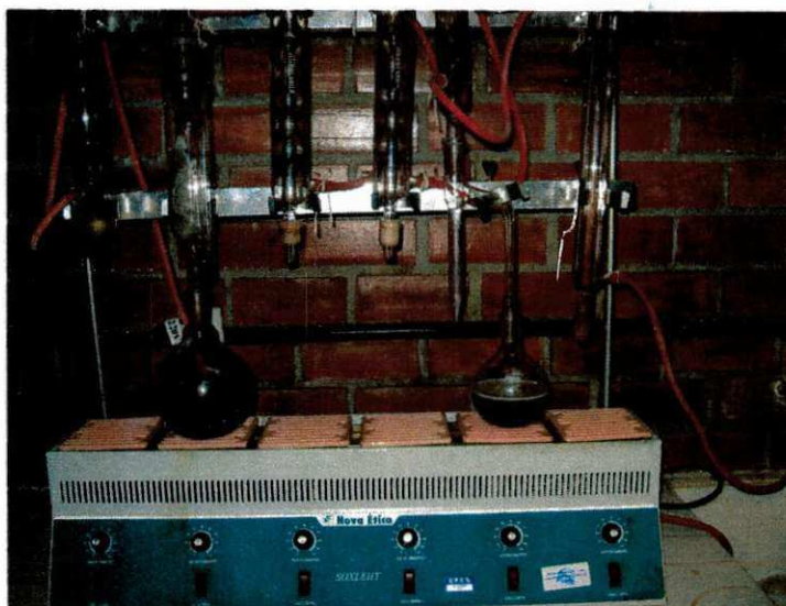
Figura 2. Determinação do teor de óleos nas sementes de nim e mamona.
