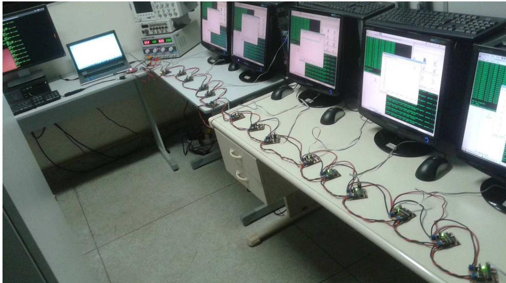
Figura 6.7: Foto da plataforma experimental para simulação de NCSs CAN.
