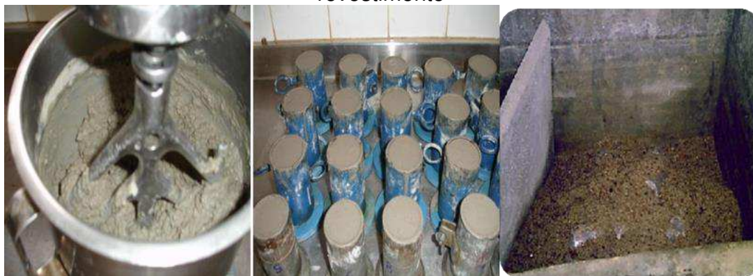
Figura 19: Preparação, moldagem e cura das argamassas de assentamento e revestimento
