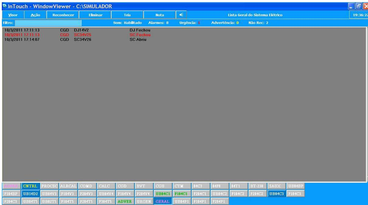
Figura 4-12 – Tela de alarmes no supervisorio do simulador, implementada no *InTouch*
