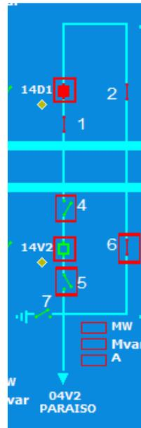
Figura 5-2 – Representação da linha de transmissão 04V2 após a realização da manobra de liberação do disjuntor 14V2
