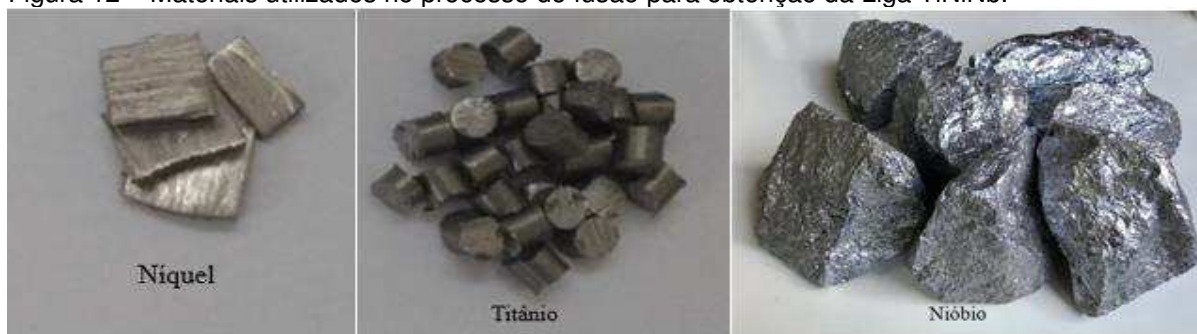
Figura 12 – Materiais utilizados no processo de fusão para obtenção da Liga TiNiNb.
