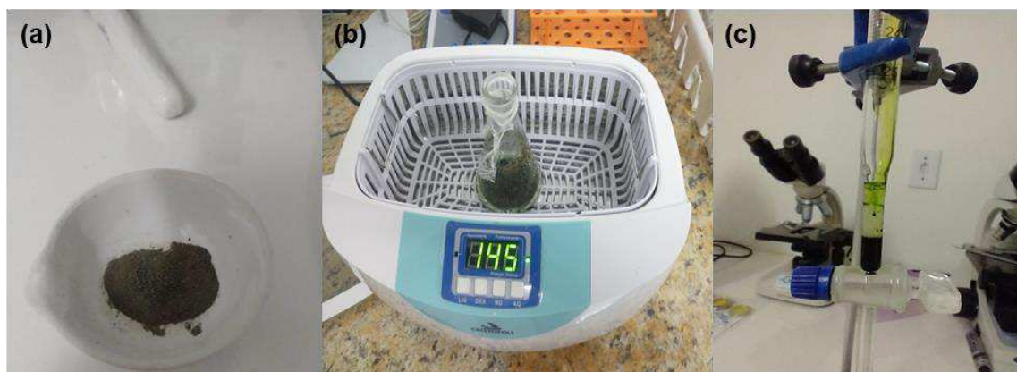
Figura 9 – Pó de biomassa seca (a), banho sônico (b) e separação de fases em bureta (c)
