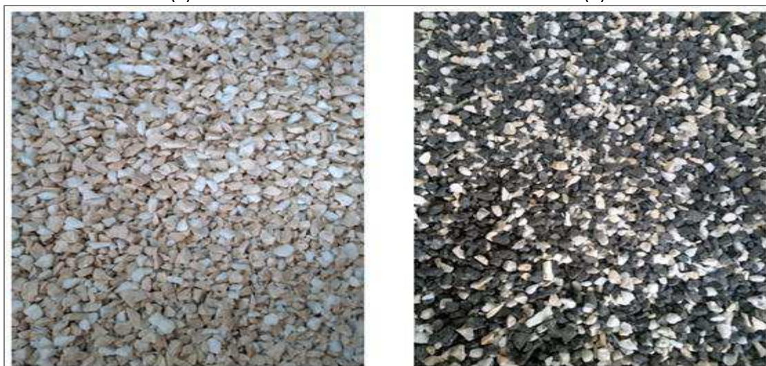
Figura 11: Resultado da britagem: (a) mármore; (b) granito
