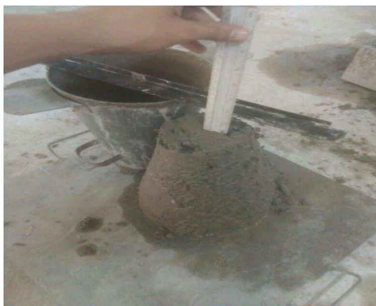
Figura 12: Ensaio de Slump Test realizado para o concreto em estudo
