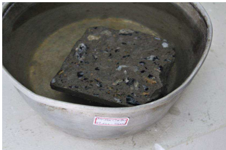
Figura 15: Ensaio de absorção de água do concreto em estudo
