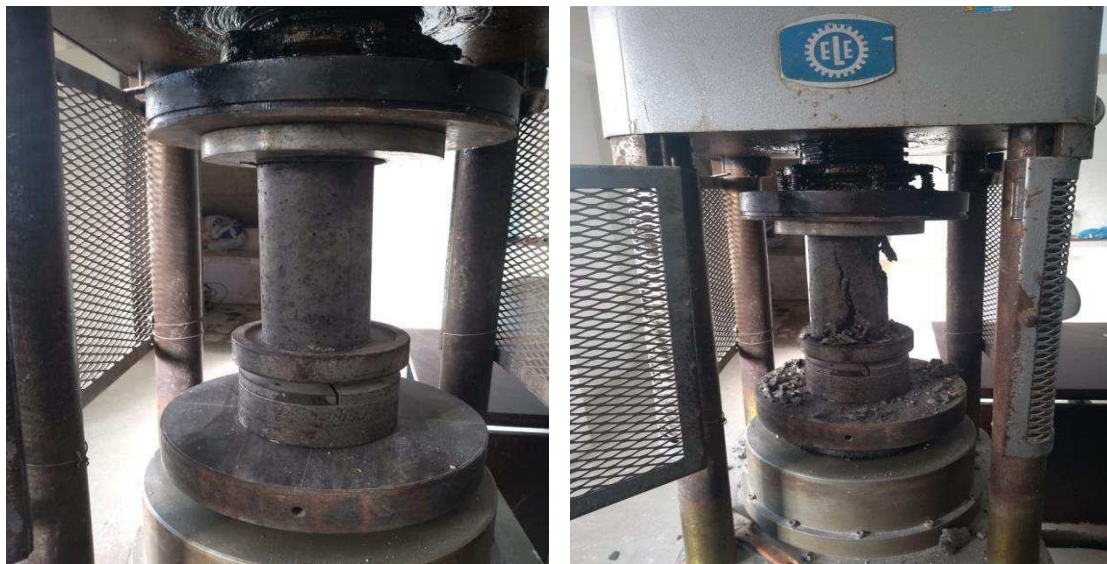
Figura 16: Ensaio de resistência à compressão simples
