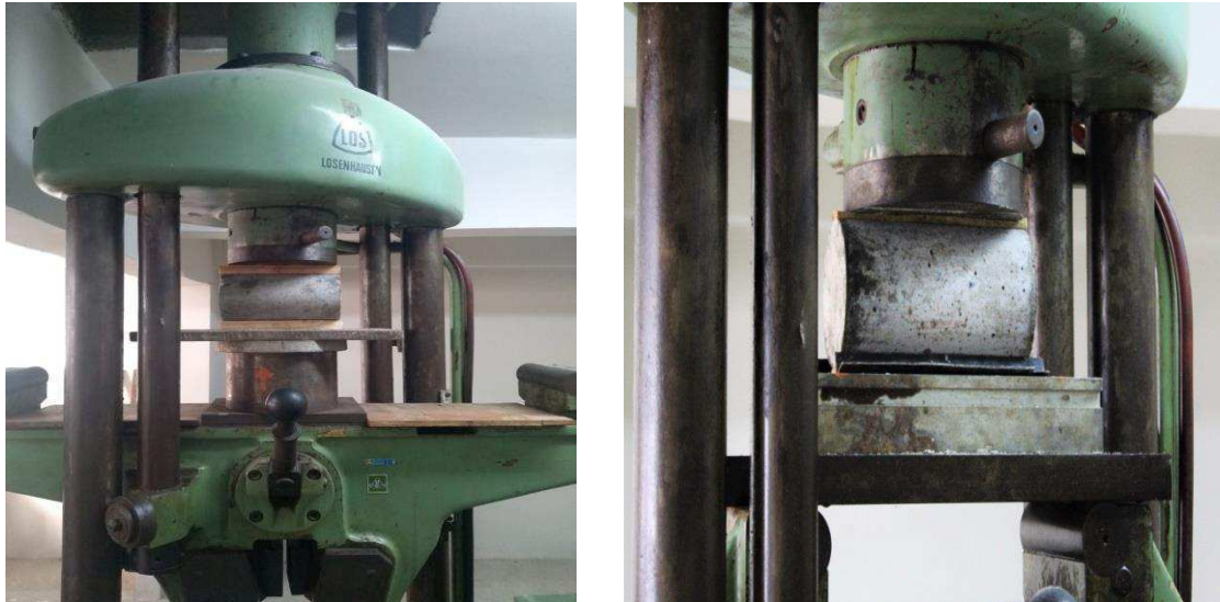
Figura 17: Ensaio de resistência à tração por compressão diametral
