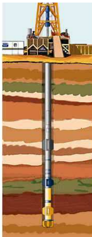
Figura 2-2 – Esquema da coluna de perfuração com broca.
