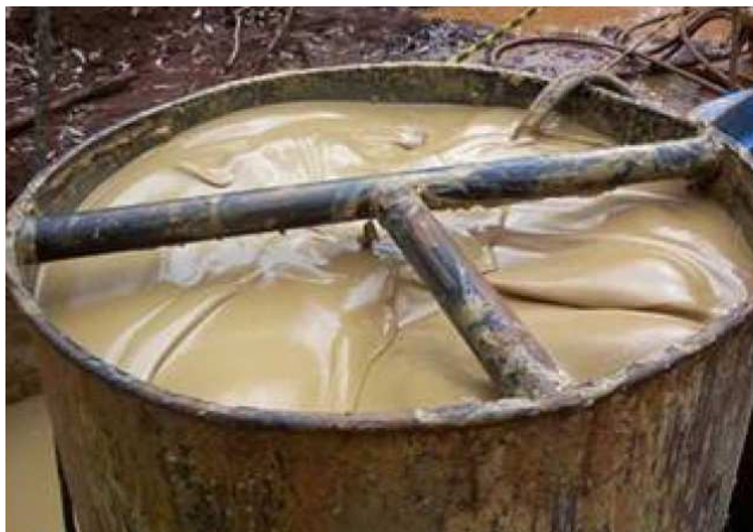
Figura 2-3 – Reservatório contendo fluido de perfuração.
