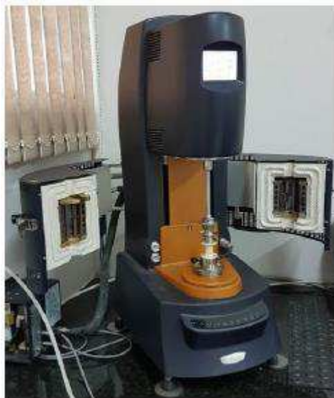
Figura 17: Reômetro de cisalhamento direto (DSR) do Laboratório de Engenharia de Pavimentos LEP/UFCG
