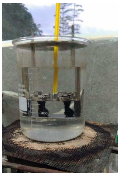
Figura 14: Realização do ensaio de ponto de amolecimento
