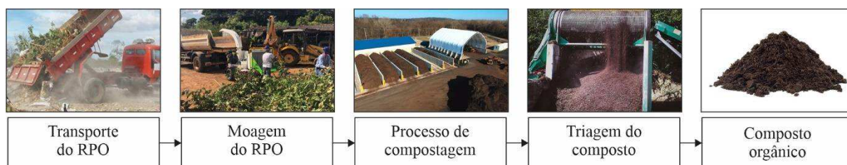
Figura 1 – Esquema de fluxo no processo de compostagem de RPO em leiras
