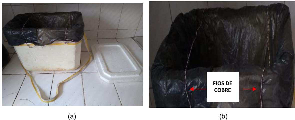
Figura 3.8 – Descrição da caixa de isopor. (a) Caixa de isopor, de dimensões 23 cm de largura, 33,5 cm de comprimento e 26 cm de altura, com 2,2 centímetro de espessura, com a tampa a esquerda; (b) Imagem da sacola e do fio onde a banana foi fixada na caixa de isopor.
