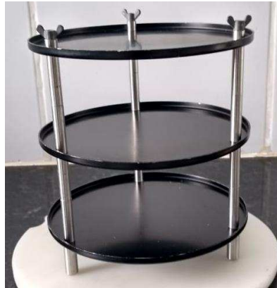
Figura 3.10 – Prateleiras não aquecidas do liofilizador.
