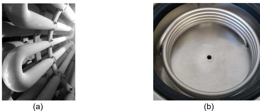
Figura 2.9 – Formato de serpentina de liofilizadores. a) Fonte: Haseley (2018); b) Foto da bobina do liofilizador Christ Alpha 1-2 LDplus.
