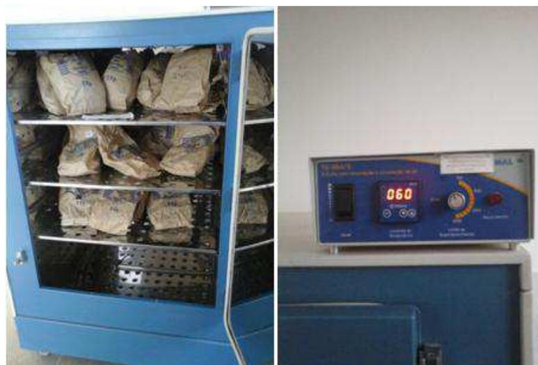
Figura 5 – Secagem das amostras da Erva Botão (*Eclipta alba* (L.) Hassk.) em estufa com circulação de ar forçado a temperatura de 60 °C. Fonte: Arquivo Pessoal (2015).
