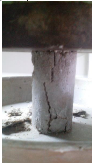
Figura 29: Rompimento dos corpos de prova dosados com 20% de resíduos de mármore.
