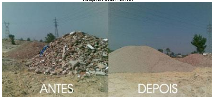
Figura 16: Resíduos gerados nas construções e demolições antes e após ser preparado para o reaproveitamento.
