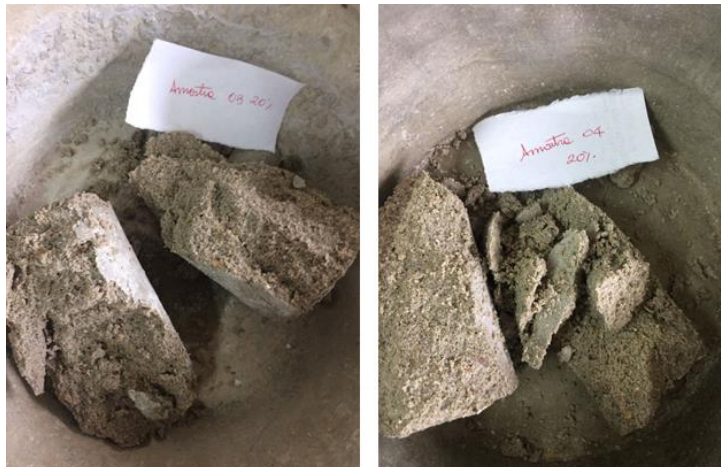
Figura 31: Amostras dosadas com 20% de resíduo de mármore rompidas.
