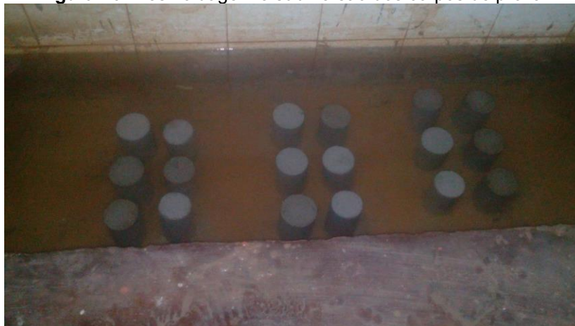
Figura 26: Desmoldagem e submersão dos corpos de prova.
