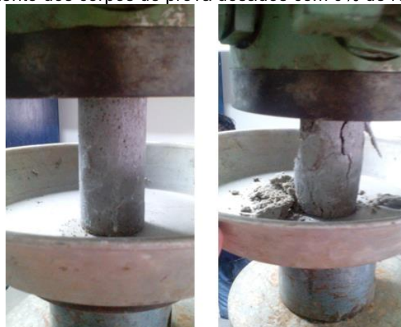
Figura 27: Rompimento dos corpos de prova dosados com 0% de resíduos de mármore.
