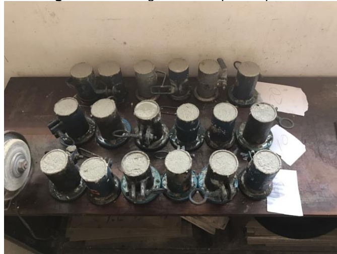
Figura 25: Moldagem dos corpos de prova.
