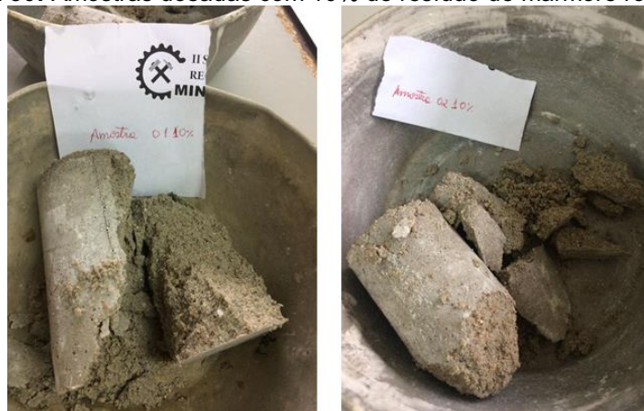
Figura 30: Amostras dosadas com 10% de resíduo de mármore rompidas.
