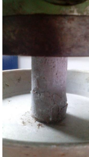
Figura 28: Rompimento dos corpos de prova dosados com 10% de resíduos de mármore.
