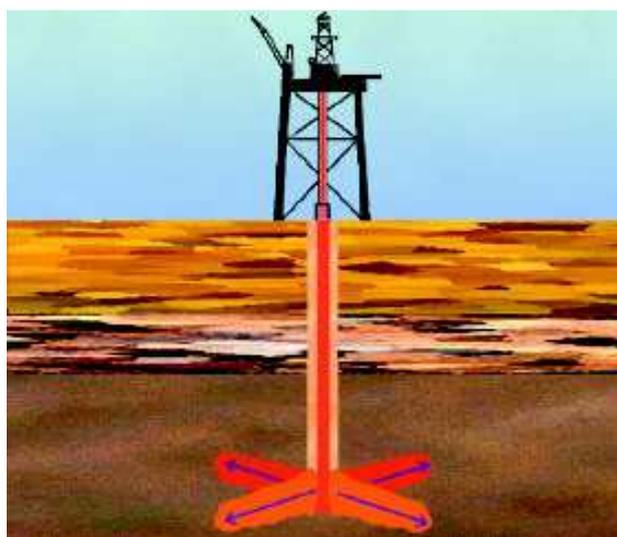
Figura 9 – Processo de re-injeção de fluidos não aquosos. Fonte: Bernier, 2003.
