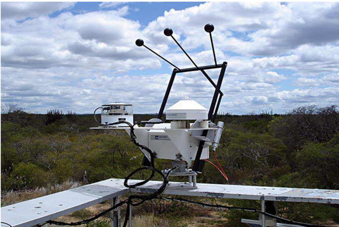
**Figura 19** - Vista do rastreador solar da estação meteorológica de Petrolina, com os três rastreadores solares: o pirgeômetro, o piranômetro e o pireliômetro.
