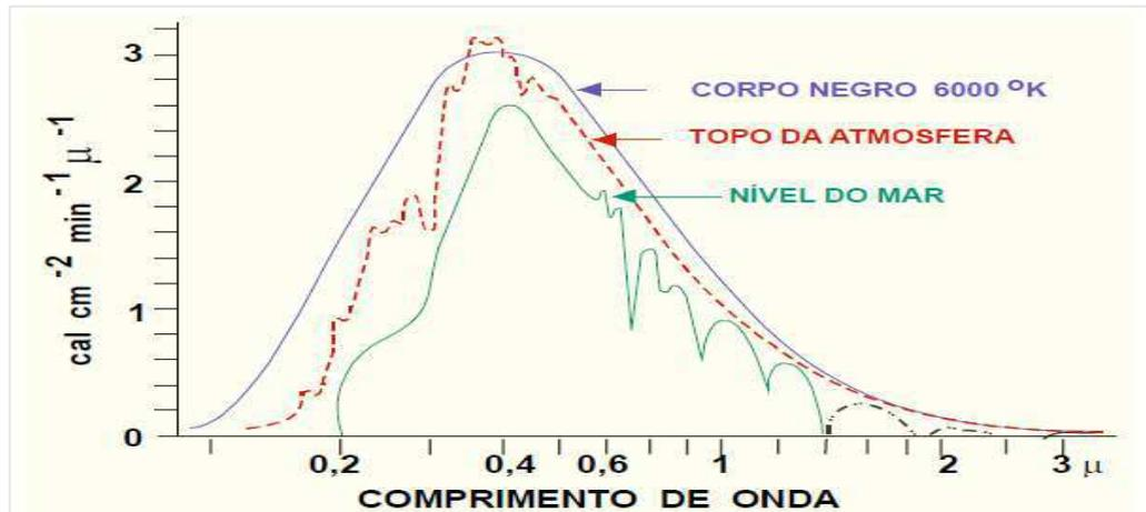
**Figura 2** - Distribuição espectral da radiação solar no topo da atmosfera e ao nível médio do mar comparadas com a da emissão de um corpo negro a 6000K (corrigida para compensar a distância média terra-sol).
