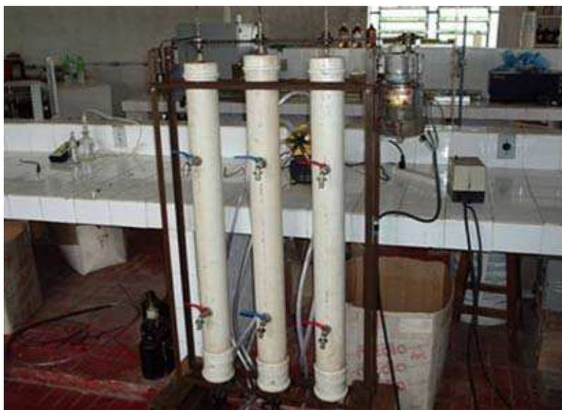
**Figura 3.1: Foto dos reatores aplicados durante a pesquisa experimental.**
