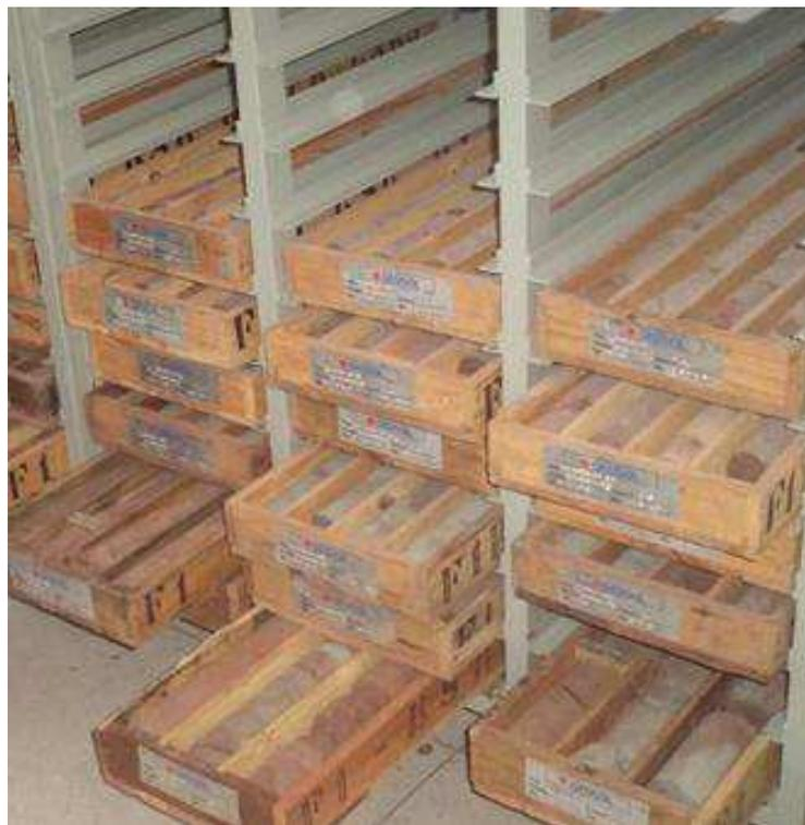
Figura 5.1: Testemunhos do furo estratigráfico 1-BSB01-PB da Bacia Rio do Peixe.
