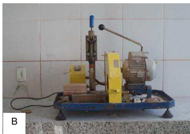
Figura 5.4: (A) Plugadeira de bancada e (B) Retificadora.
