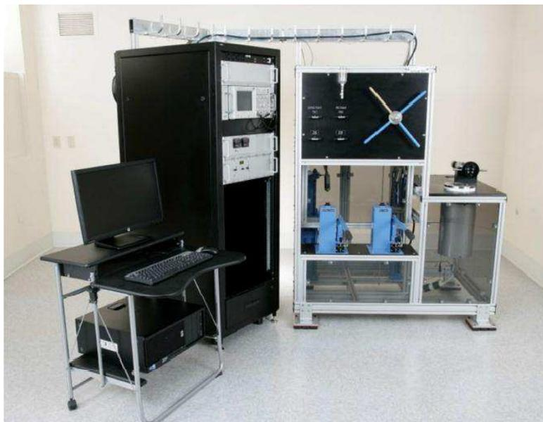
Figura 5.35: Autolab 500<sup>®</sup> utilizado para a medição das propriedades elásticas.
