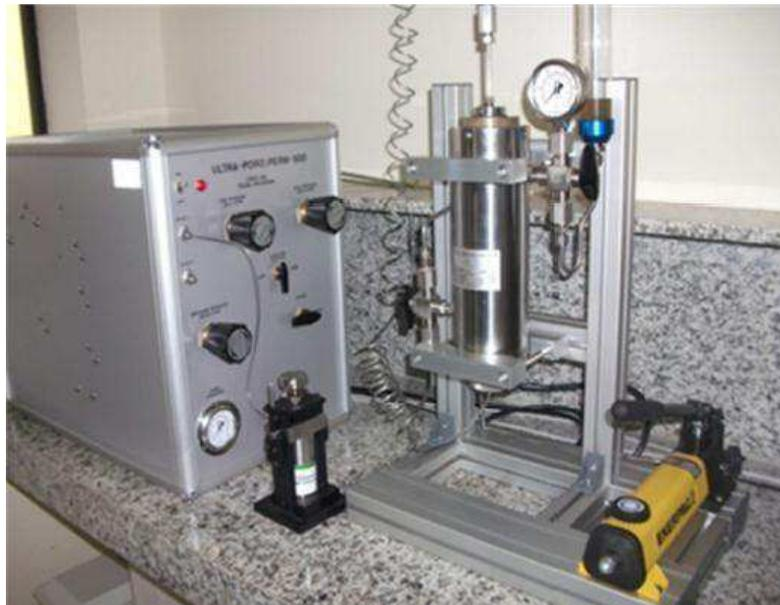
Figura 5.28: Ultra-Pore-Perm 500<sup>®</sup> utilizado nos ensaios físicos de porosidade e permeabilidade.
