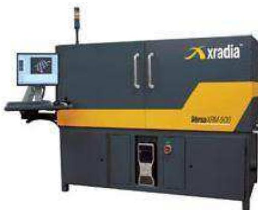
Figura 5.6: Microtomógrafo Versa XRM – 500.
