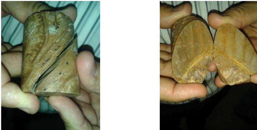
Figura 6.29: Imagem de uma amostra de Tufa CR com a presença de matéria orgânica vegetal.
