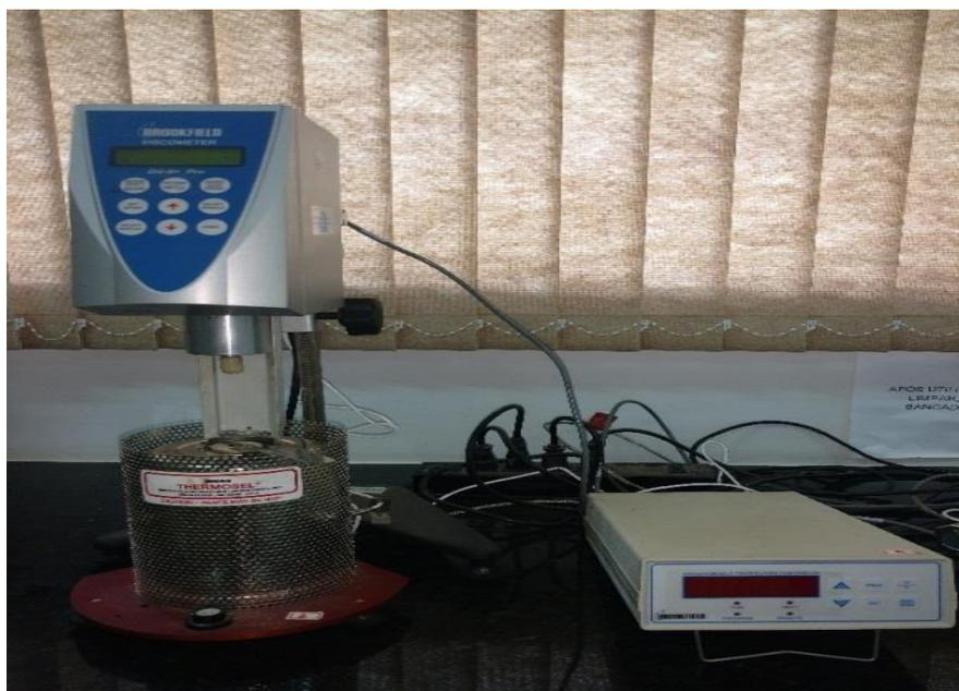
A viscosidade é medida, então, por meio do torque necessário para girar o spindle imerso na amostra de asfalto nas velocidades de 20, 50 e 100 rpm, respectivamente às temperaturas do ensaio supracitadas. Essa propriedade foi medida, antes e após o envelhecimento a curto prazo, em todas as amostras.
