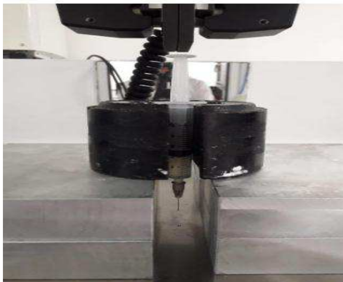
Figura 30 – Adaptação de ensaio para realização da medida de injetabilidade/força de ejeção.
