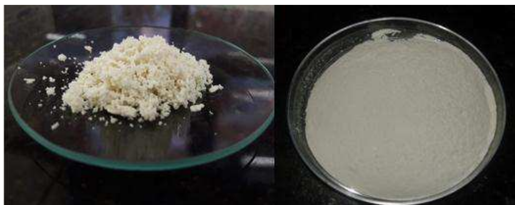
Figura 28 – Colágeno liofilizado antes (A) e após macerado e peneirado em malha 325 mesh (B).
