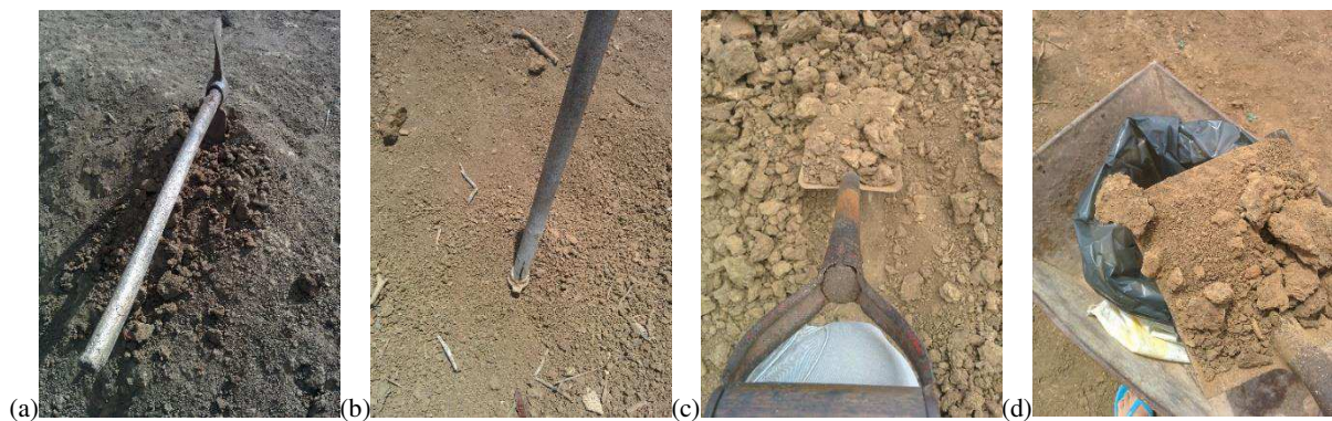
Figura 9 – (a) Picarete, (b) enxada, (c) pá e (d) saco plástico para transporte e armazenamento.
