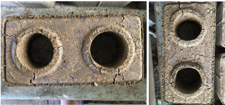
Figura 32 – Tijolos constituídos solo argiloso e manipueira conformados em prensa mecânica.
