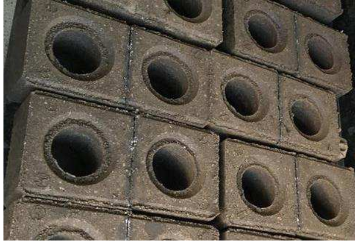
Figura 36 – Tijolos produzidos na prensa hidráulica, com câmara dividida no centro, com massa constituída de solo argiloso, areia e manipueira.
