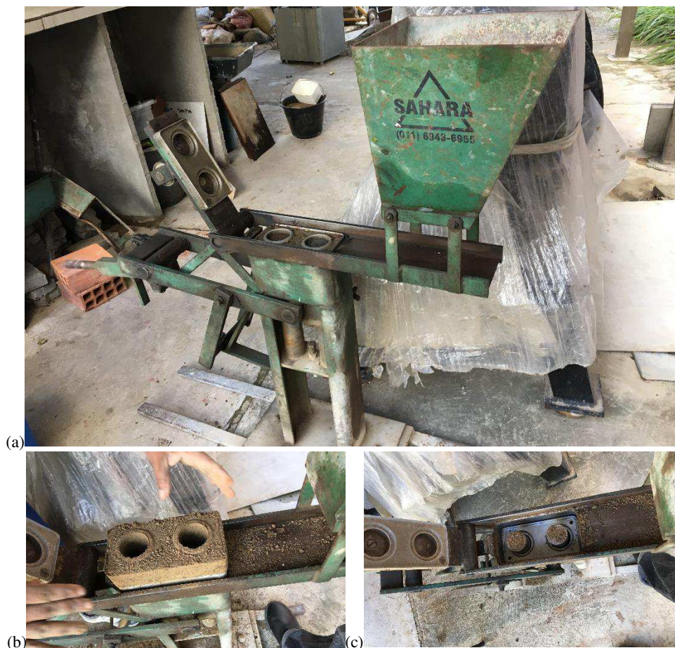
Figura 17 – (a) Prensa Sahara para tijolos ecológicos, (b) tijolo sendo ejetado após a prensagem e (c) câmara de prensagem.
