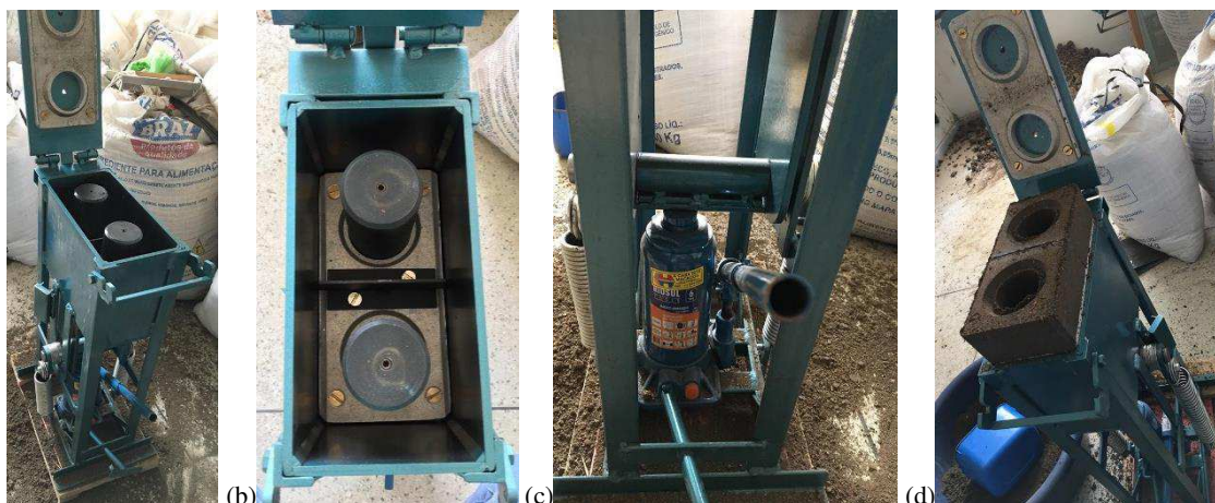
Figura 19 – (a) Prensa Hayabusa para tijolos ecológicos, (b) câmara de prensagem dividida no meio, (c) macaco hidráulico de 6 toneladas e (d) tijolo sendo ejetado após a prensagem.
