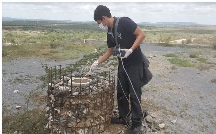
Figura 6 - Medição de concentração de gases nos Drenos Verticais
