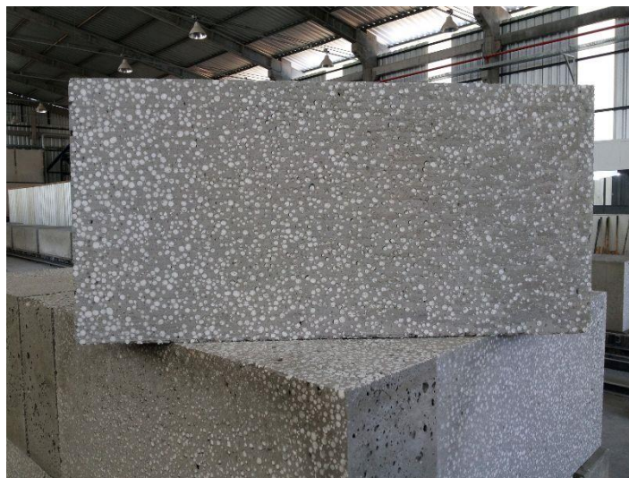
Figura 4: Concreto leve – Bloco com EPS reciclável
