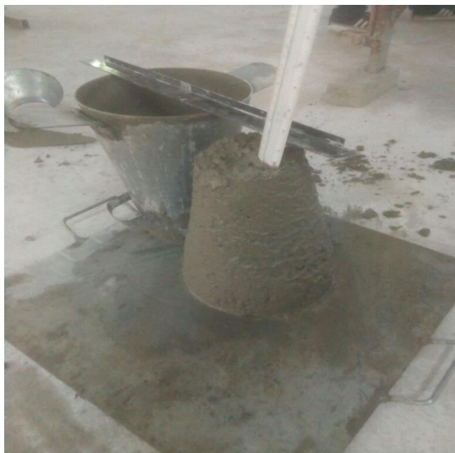
Figura 15: Ensaio de consistência (slump test).
