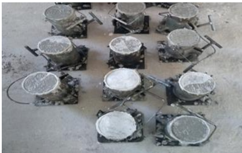
Figura 16: Moldagem dos corpos de prova de concreto incorporados com resíduo de quartzito em pó nos teores de 10% e 20%.
